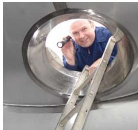
En silotank er lidt sværere at inspicere end de indendørs tanke. Men det er samtidigt afgørende for at holde kimtallet nede, understreger Henrik Abildgård, som her inspicerer en tank. Foto: Mejeriforeningen.
