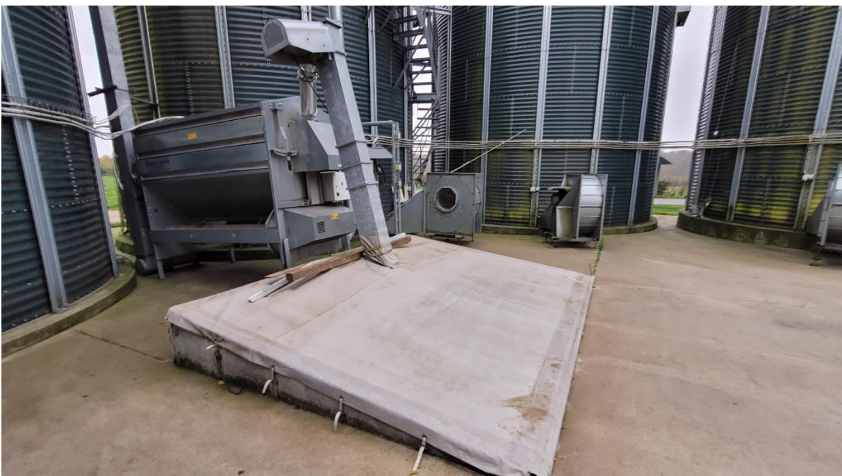
Billede 16. Korngrav med forrensning før transportanlægget. Foto. Jens Erik Iversen, SUKUP Europe.
