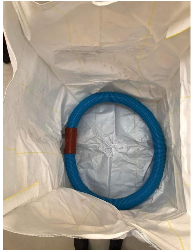
Billede 2. Drønrør anbefales med en diameter på \geq 200 mm.
