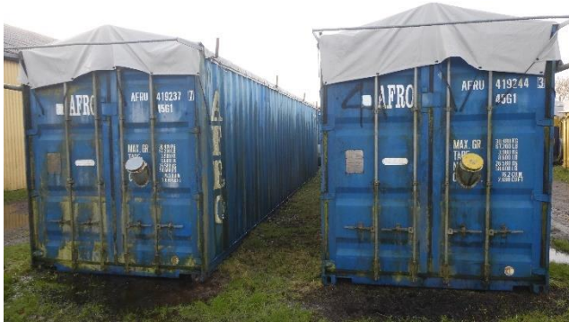
Billede 9. Containere opstillet udendørs med presenningstag. Billede 10. Studsen i containerens side til prøvetagning. Fotos: Henning Sjørsløv Lyngvig, SEGES
