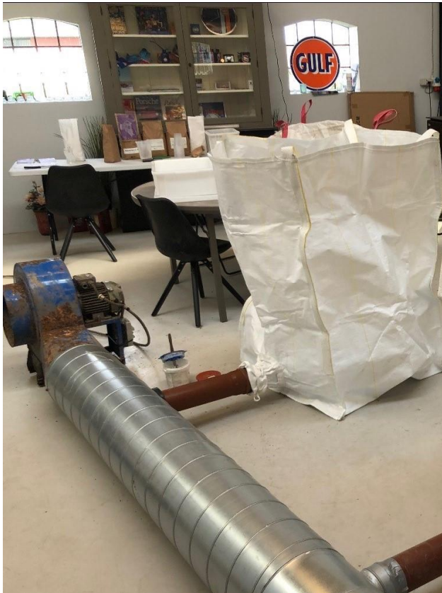
Billede 1. Opsætning med improviseret hovedkanel. Fotos: Visti Møller, GI. Buurholt
