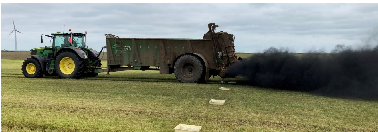
Spredning af biokul med Bredal K-XE kalkspreder (øverst) og Samson SPE-21 universalspreder (nederst). Fotos: Henning Sjørlev Lyngvig, SEGES Innovation.
