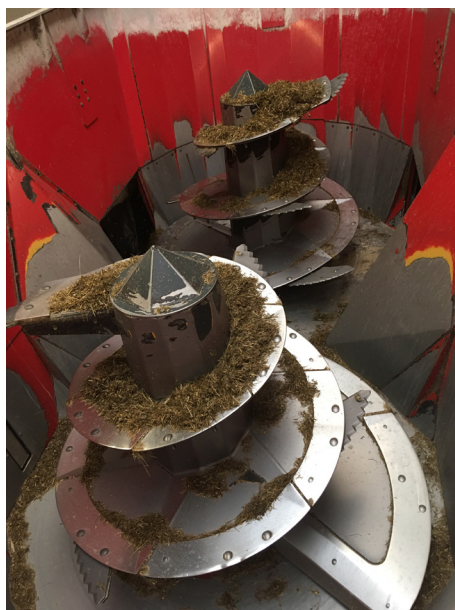
Bare det at glide på gulvet i foderblanderen kan give voldsomme snitsår og i værste fald amputationer. Foto:SEGES
