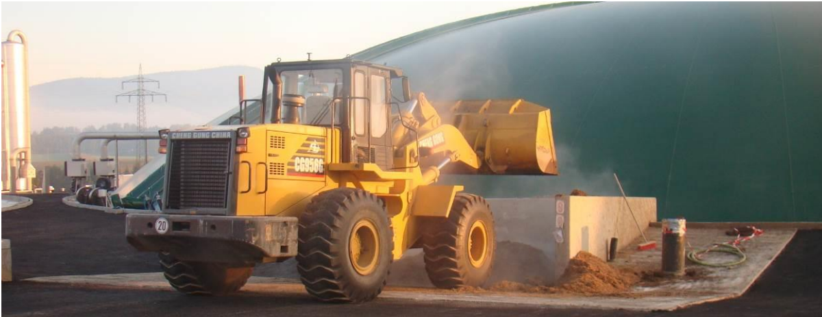
Figur 8: Indføding af faste biomasser i Sauter-anlæg
