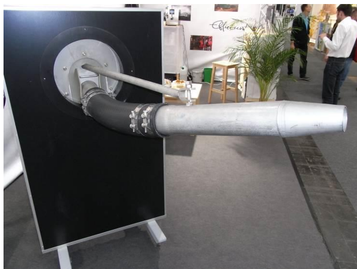
Figur 9: Overrislingssystem og dyse i Sauter-anlæg. Opvarmning sker gennem ekstern varmeveksler.
