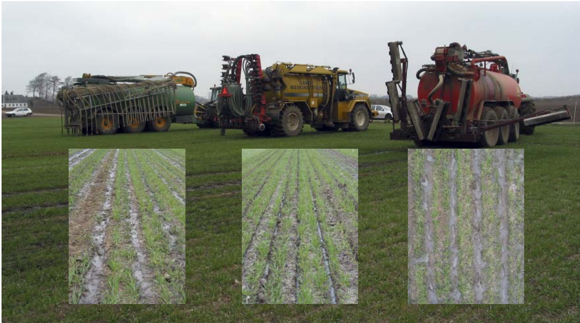
Figur 2.3. Tre af de fire forskellige udbringningsteknikker anvendt i forsøgene. Fra venstre er det slangeudlægger, skiveskærnedfælder og DGI-nedfælder. De små billeder viser afgrøden efter overkørsel med de forskellige udbringningsteknikker.
