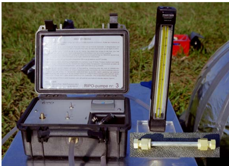
Figur 2.2. Pumpe og flowmåler til udtagning af prøver for ATD-GCMS. Det lille billede viser adsorptionsrøret monteret med propper i begge ender.
