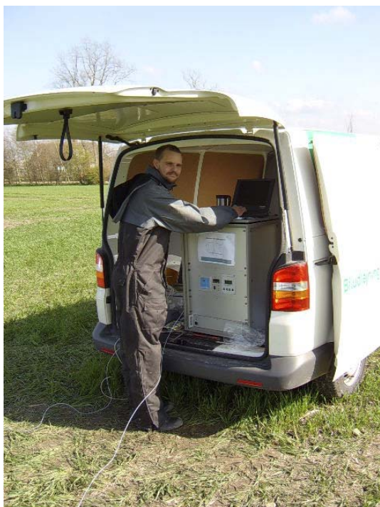
Figur 2.1. MIMS-udstyret er monteret i en varevogn, så det er muligt at foretage feltmålinger.
