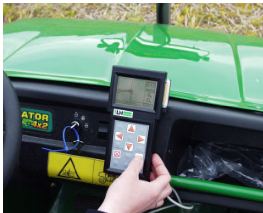
Figur 4.2 Terminal til Swath XL. På skærmen vises det aktuelle og de foregående spors placering.
