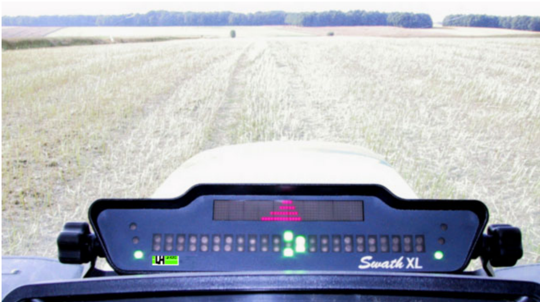
Figur 3.1 Lysbar fra LH Technologies med lysende dioder.
