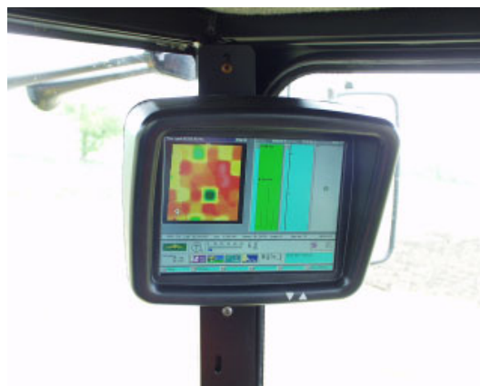
Figur 4.6 På skærmen vises de gennemkørte spor, og hvor man aktuelt befinder sig på marken.
