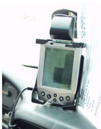
Figur 4.4 Lommecomputeren med SatFoam-programmet var under testen fastgjort til bilruden.
