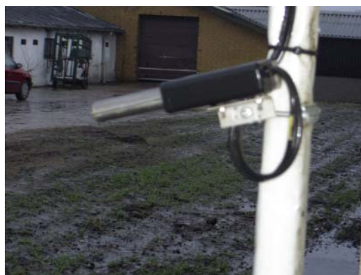
Figur 6.8. Regnsensoren fungerer fint i almindeligt regnvejr. Den har problemer i støvregn og snevejr, som den ikke kan registrere.
