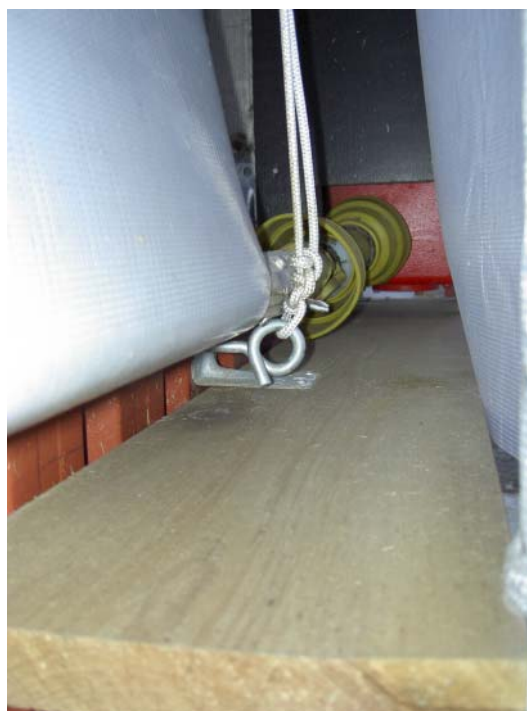
Figur 6.18. En elmotor klarer oprulningen via en aksel, som er forbundet til bommen. Oprulningen sker via stålwirer.
