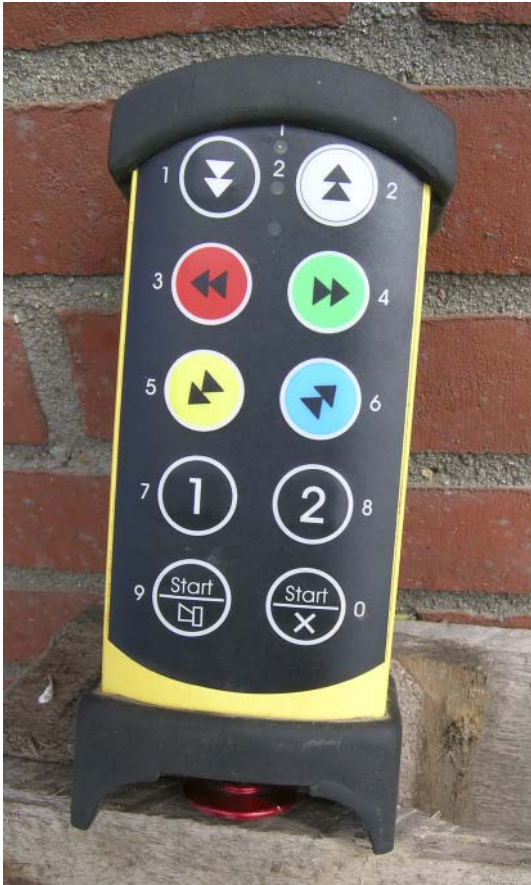
Figur 6.27. Styringen sker manuelt med en fjernbetjening eller stationære trykknapper. Her ses fjernbetjeningen.
