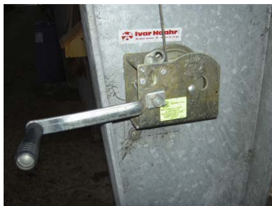
Figur 6.40. Håndsvinget, som betjener gardinet. Der er også mulighed for automatisk betjening og styring med vejrstation.
