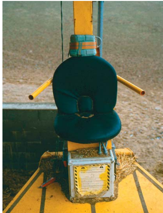
Figur 59. Førersædet på Bale-feeder, som indtages for at få maskinen til at køre.
