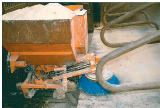
Figur 18. Maskinen har tre funktioner; den strør, fejer og skraber samtidig. Alle funktioner leverer et tilfredsstillende resultat.
