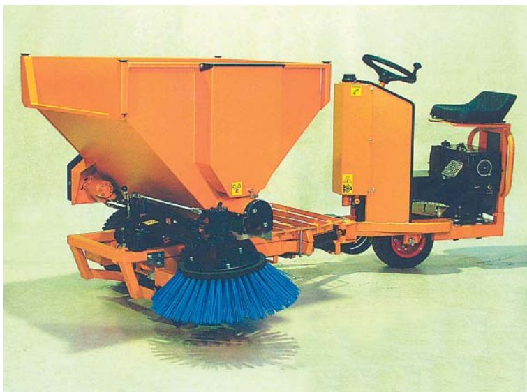
Figur 71. Lydersen strømmaskine er en 3-i-1-maskine, som strør, fejer og skraber spalterne.
