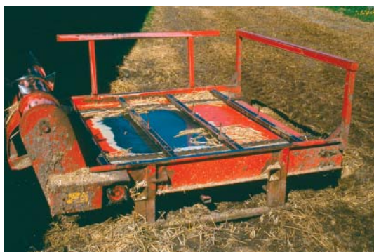
Figur 86. Rondo-Dan rundballeafvikler er liftophængt. Selve afvikleren er monteret på halmspyddet.
