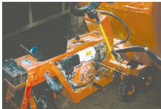
Figur 16. Motoren er på 9 hk. Dette er i underkanten ved spidsbelastninger.
