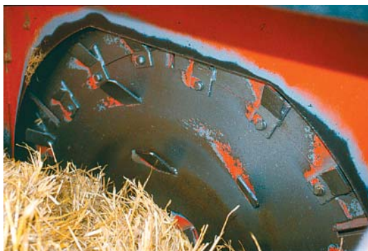
Figur 37. Snitemøllen snitter halmen inden den strøs. Der er ikke tendenser til dannelse af prop, men stor fare for fremmedlegemer i spredezonen.
