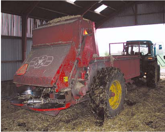
Figur 47. RKM er bygget til møgspredning, men kan også bruges til halmspredning på dybstrøelsesarealet.
