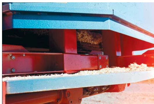
Figur 29. Strøelsen slynges ud ved hjælp af spredeblade.
