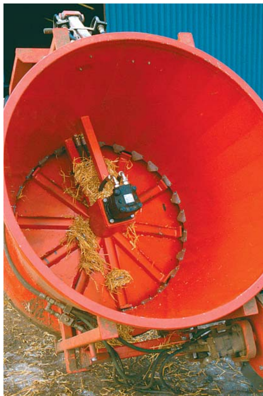
Figur 22. En oliemotor i midten af beholderen driver spredhjulet. Placeringen gør, at maskinen ikke kan håndtere hele baller.
