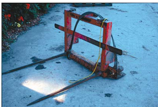
Figur 52. Halmspydet er liftophængt og bruges til at læsse ballen på afvikleren. Derefter monteres afvikleren let på spydet.
