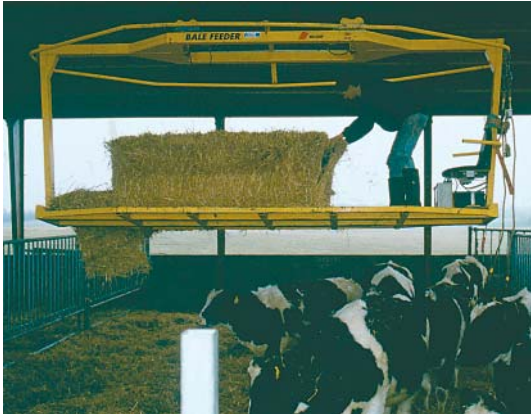
Figur 58. Skiold Mullerup Bale-feeder er en manuel betjent strømaskine, som er skinneophængt over dybstrøelses-arealet.
