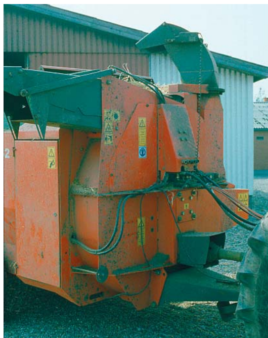
Figur 46. Maskinen er monteret med en drejbar tud (til højre), som er ekstraudstyr. Den forbedre maskinens strømulighederne betydeligt.
