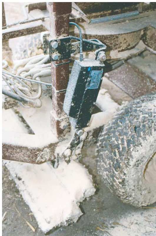
Figur 10. Skrabebladet hæves og sænkes elektrisk. Konstruktionen er for spinkel og ikke tilstrækkelig driftssikker.
