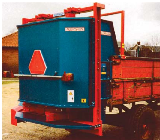
Figur 28 . Strømaskinen monteres bag på en aflæsservogn.
