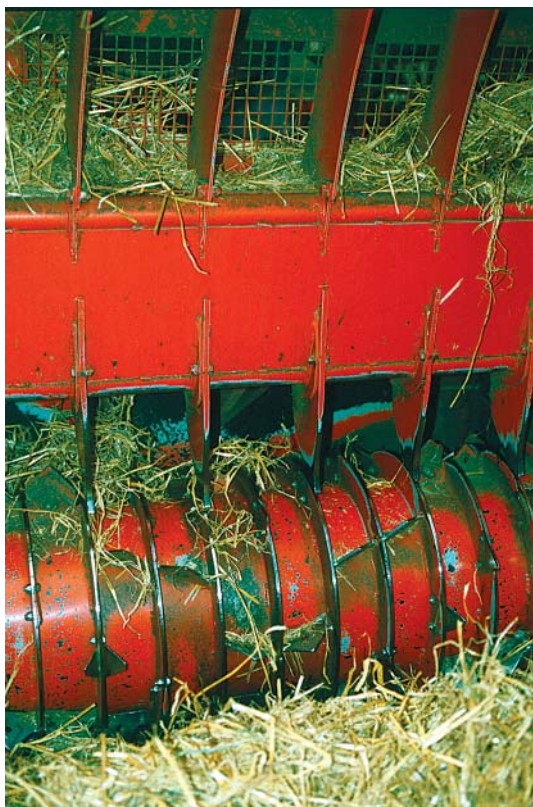
Figur 64. Oprivealsen er kraftigt dimensioneret og fungerer efter hensigten. Antallet af tænder kan varieres.
