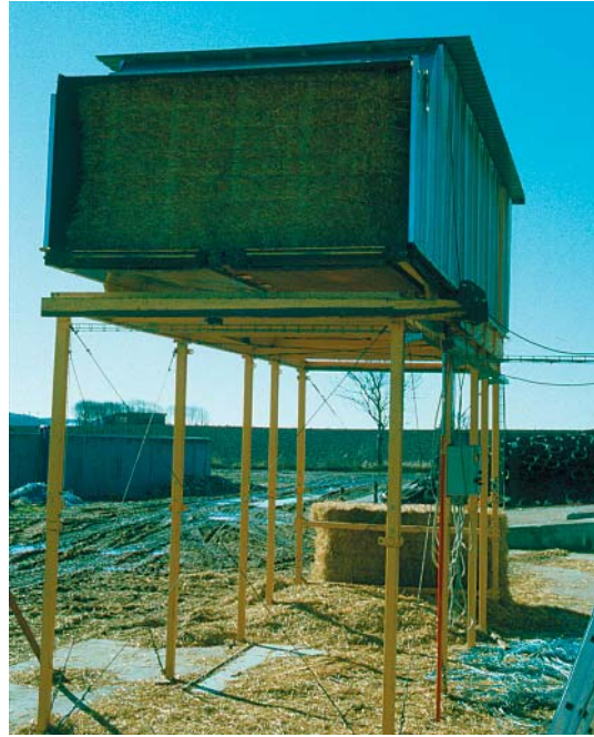
Figur 55. Læseanlægget er en prototype, som automatisk kan læsse strømaskinen. Stationen kan rumme fire bigballer.
