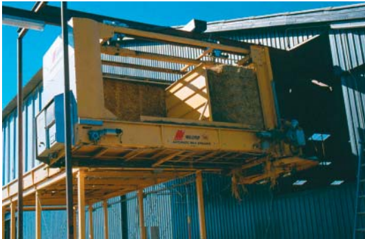
Figur 56. Strømaskinen kan selv køre ud og hente en ny balle fra læsseanlægget. Ballens snore skal fjernes manuelt.
