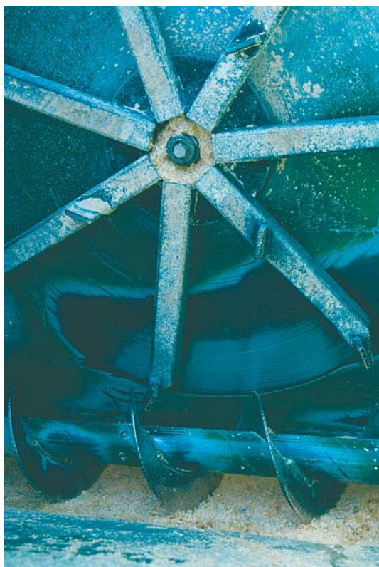
Figur 7. Maskinen strør ved hjælp af en omrøremølle, snegl og spredetallerken. Der er ikke tendens til dannelse af prop, med mindre strøelsen er fugtig.
