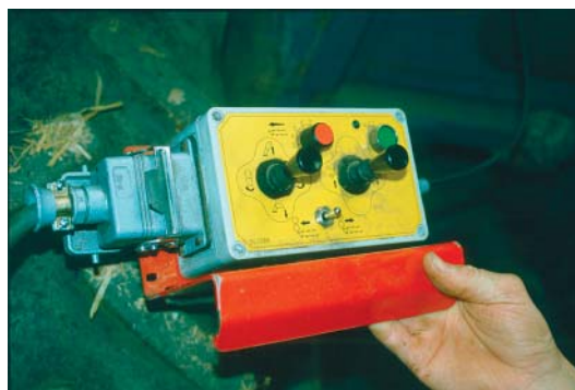
Figur 65. Betjeningen af maskinen er god. Den foregår ved hjælp af en boks fra traktoren. Alle funktioner kan styres uafhængigt af hinanden.
