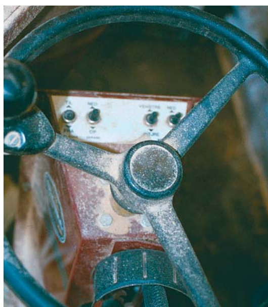
Figur 12. Indkobling af kost og skraber foregår ved hjælp af kontakter, som er betjeningsvenlige.
