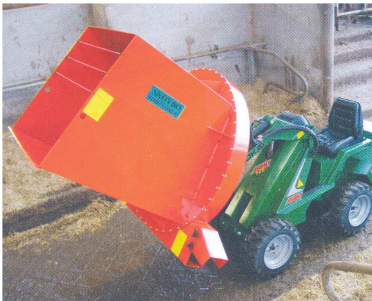
Figur 75. Skovbo's strømaskine fås i to størrelser. Begge med en beholderbredde på 0,9 meter. Længden varierer, hvor MBK har en 1,2 meter beholder og MBL har en 2,4 meter beholder.
