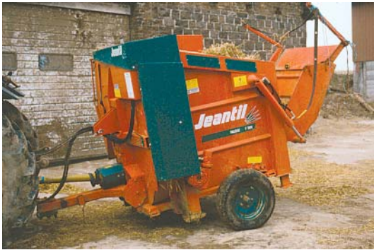
Figur 80. Modellen 2800 fås både som liftophængt og bugseret. Bagklappen bruges som læsseport til rundballer.
