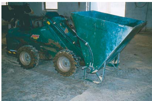
Figur 5. Avants strøkasse monteret på en minilæsser. Strømaskinen er selv-læssende ved at tippe beholderen og bruge den som skovl.
