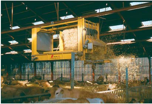
Figur 54. Skiold Mullerup ABS er en fuldautomatisk strømaskine, som kører på en skinne over dybstrøelsen.
