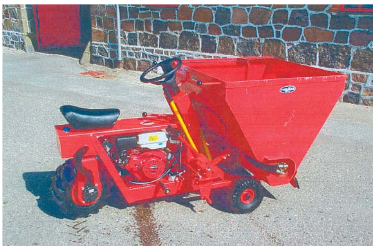
Figur 70. Bobman fås i forskellige udgaver med 1 eller 3 WD, benzin eller diesel. Der fås 10-12 forskellige redskaber til maskinen.
