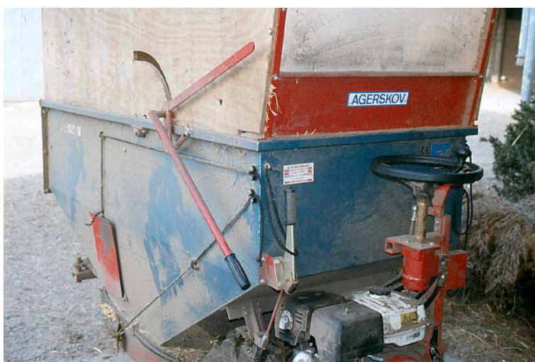
Figur 66. HS 8080 er Agerskovs største maskine til strøning af sengebåse. Den strør både med snittet halm, savsmuld og spåner.
