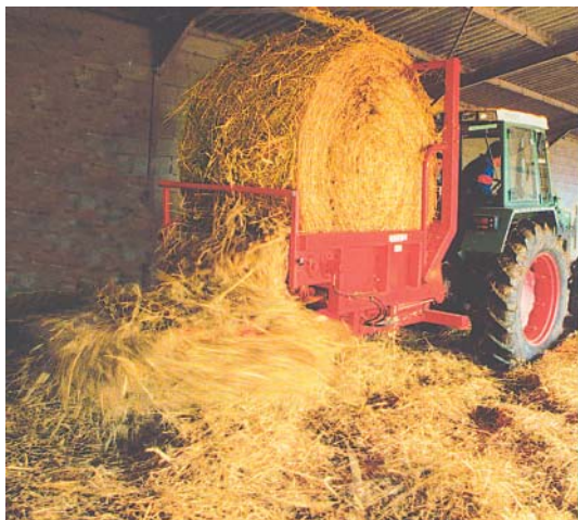
Figur 77. Model 160 er til strøning af rundballer. Maskinen fås i forskellige typer til både traktor og teleskoplæsser.
