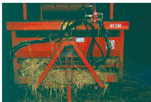
Figur 34. A-rammen er blevet forstærket, idet den var for spinkel. Selve monteringen af maskinen er hurtig og brugervenlig.
