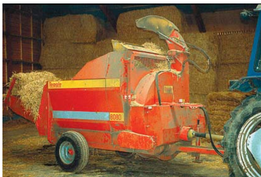
Figur 62. Tomahawk 8080 er en kraftig maskine med en spredelængde på 16 meter. Den drejbare tud er ekstra-udstyr.
