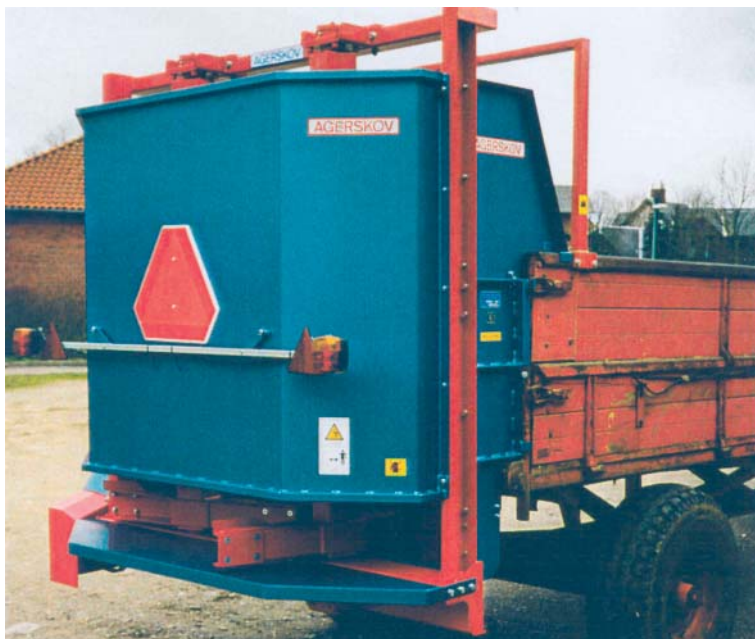
Figur 76. HSV er monteret på en aflæsservogn med bundkæde.
