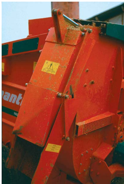
Figur 38. Spredetuden kan justeres op og ned efter behov. En drejbar model fås som ekstraudstyr.
