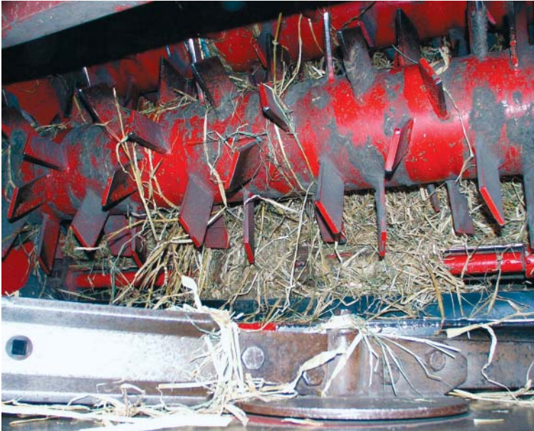
Figur 49. Valsen er monteret med kraftige oprivere. Desværre er der ingen velfungerende kobling. Det betyder, at maskinen kan ødelægge kæde, gear og kraftoverførsel, hvis halmen sætter sig fast.
