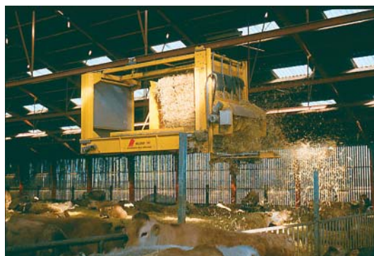
Figur 90. ABS er fuldautomatisk og kan programmeres til at strø efter ønske.
