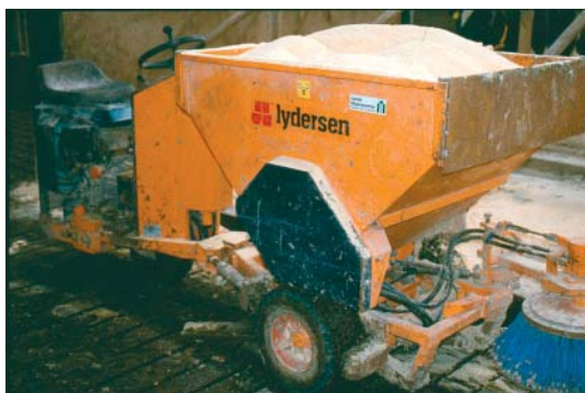
Figur 17. Lydersens strømaskine er robust og brugervenlig. Desværre kan den kun håndtere fintsnittet halm.
