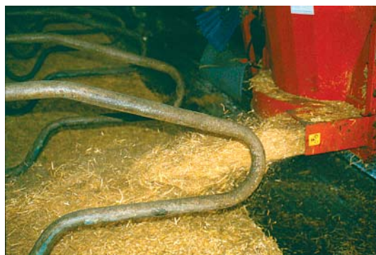
Figur 24. Strøningen er ensartet og spredelængden tilfredsstillende. Der opstår mindre støvgener under spredningen.
