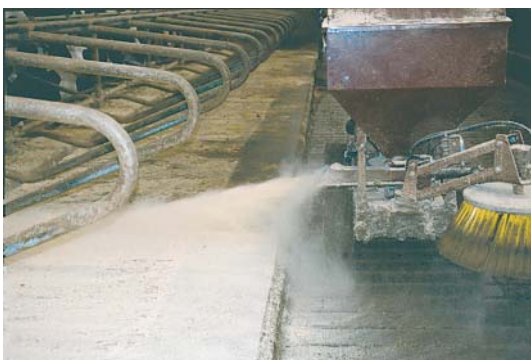
Figur 11. Maskinen strør, fejer og skraber med et tilfredsstillende resultat.
