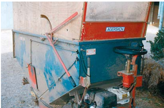
Figur 1. Agerskov Strømester HS 8080. Bemærk de hjemmelavede høje sider. Der kan, som ekstraudstyr, leveres høje sider fra Agerskov.
