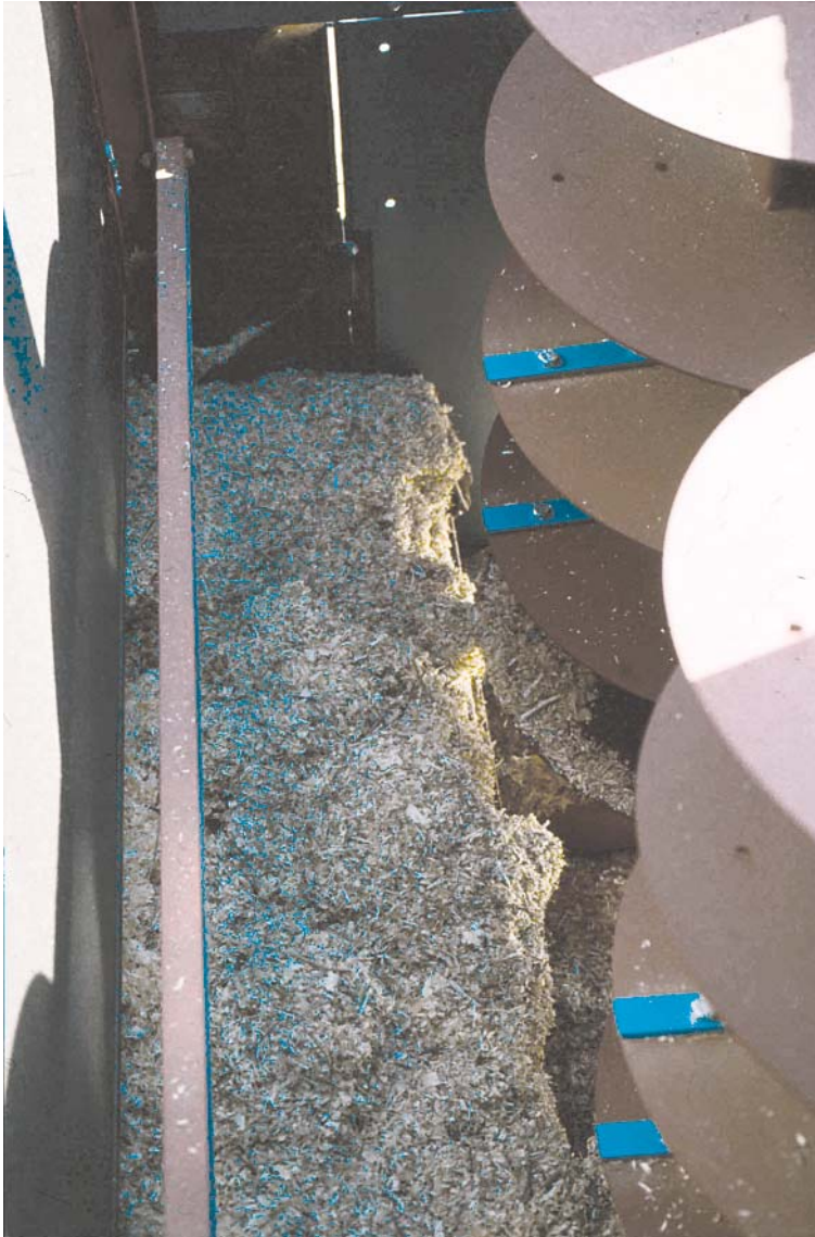
Figur 30. Testmaskinen strør med spåner og snittet rapshalm. Der er monteret en justerbar plade (til venstre på foto) for at begrænse strøsmængden.
