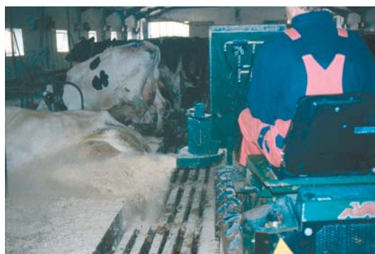
Figur 8. Avant strømaskinen strør ensartet med en spredelængde på op til 6 meter.
