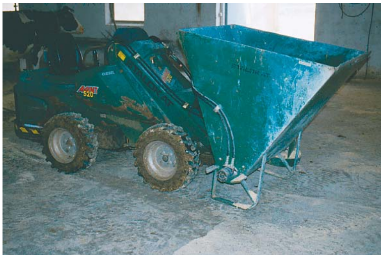
Figur 67. Avant strømmaskinen er monteret på en minilæsser. Maskinen er selvløssende ved at benytte sprederen som skovl.
