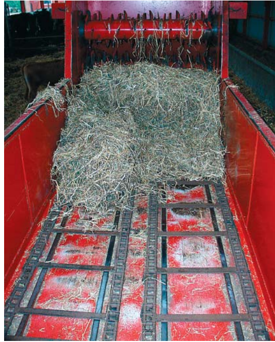
Figur 48. Halmen bringes til oprivervalserne ved hjælp af to bundkæder. Hele maskinen er kraftigt dimensioneret.
