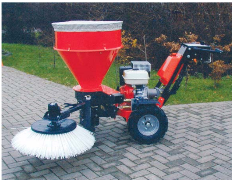
Figur 74. TriXon tilbyder to forskellige skubbemodeller, som begge kan monteres med kost og skraber. De fås i benzin og dieseludgave.
