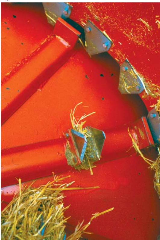
Figur 23. Spredenhjul og beholder er monteret med knive, som snitter og opriver halmen. Knivene er følsomme overfor fremmedlegemer, men er lette og billige at skifte.
