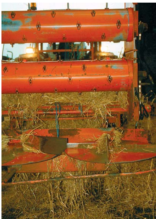
Figur 33. Opriver og spredetallerkener fungerer upåklageligt og giver en god spredning af strøelsen.
