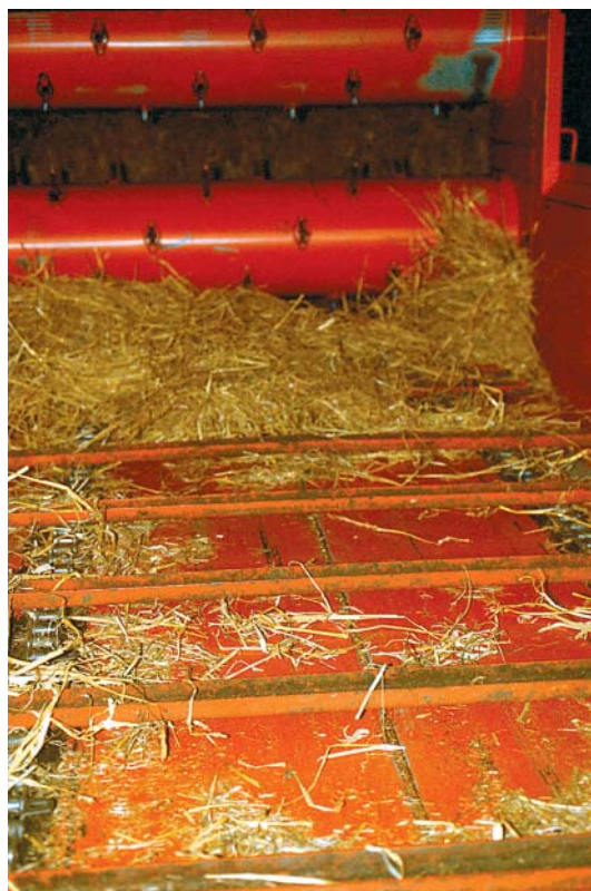
Figur 32. Bundkæde og spredetallerkenerne kunne være kraftigere dimensioneret.
