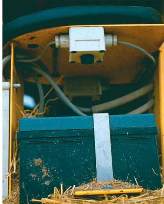
Figur 61. For at køre maskinen påvirkes to knapper under sædet. Det er ikke muligt for samme person at køre og strø samtidig.
