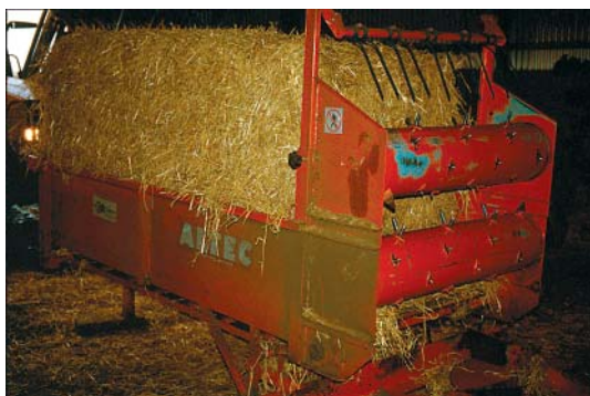
Figur 31. Altec 120 er liftophængt og kræver derfor en relativ stor traktor.
