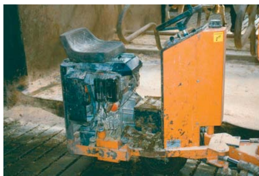
Figur 20. Motoren fra Lombardini er på 11 kW og leverer tilstrækkelig trækraft. Den støjer desværre en del.
