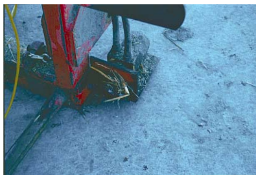
Figur 53. Oliemotoren på spydet er koblet på traktorhydraulikken. Når afvikleren monteres på spydet, kobler oliemotoren automatisk ind på afviklerens mekanik.
