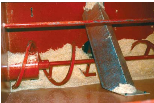
Figur 15. Bobmans strøegenskaber er tilfredsstillende. Der er dog tendens til dannelse af prop i spredereøret. Der er derfor med succes eftermonteret en afdækningsplade over hullet.
