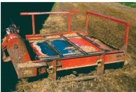
Figur 50. Rondo-Dan rundballeafvikler er liftophængt. Maskinen består af to dele. En afvikler (vist her) og et liftophængt halmspyd, hvorpå afvikleren tilkøbes.
