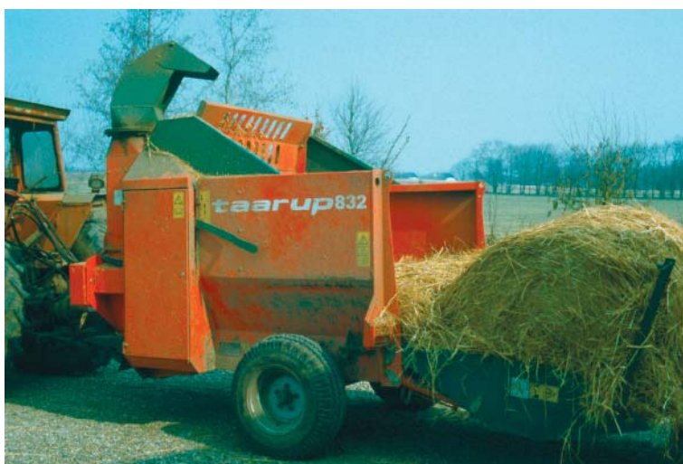
Figur 84. Kverneland producerer tre modeller, eneste variation er beholderstørrelse. Alle maskiner er bugserede.
