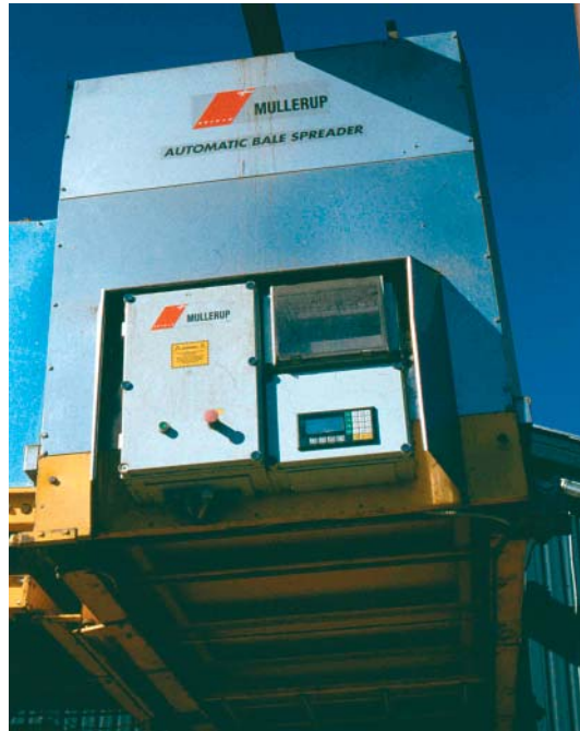
Figur 57. Strømaskinen betjenes ved hjælp af en brugervenlig computer. Den kan programmeres til at strø efter individuelle behov.
