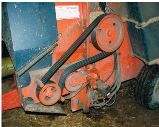
Figur 41. Maskinen er solid og driftssikker. Her ses trækket til valsen, som er let tilgængeligt bag en skærm.
