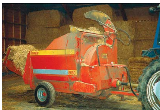
Figur 92. Den bugserede model uden snitter.
