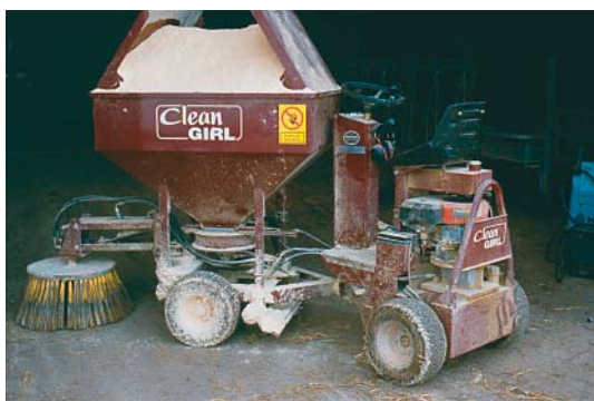
Figur 9. Clean Girl er en selvkørende strømaskine, som kan monteres med kost og spalteskraber.
