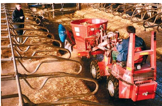
Figur 72. RIOH MS 900 med en spredelængde på 2 meter med halm. Maskinen drives af minilæsserens olieudtag.
