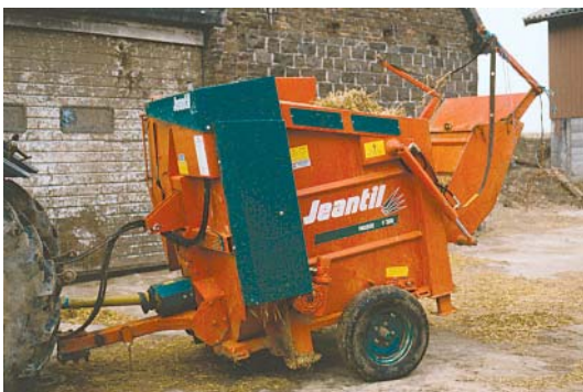
Figur 35. Jeantil AP 2800 i den bugserede udgave. Desværre er der visse fejl ved hjul- og trækstangskonstruktionen.
