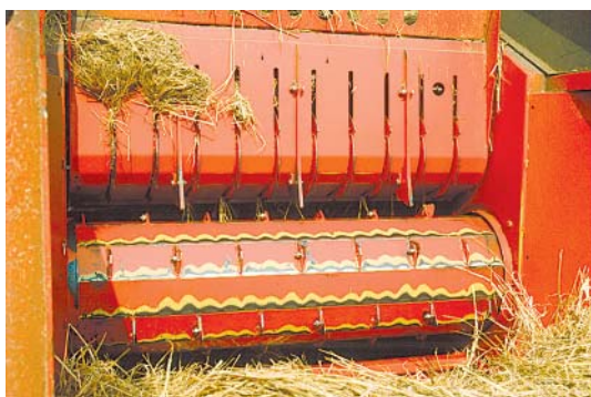
Figur 45. Opriveprincippet fungerer fint og strøresultatet er meget ensartet.
