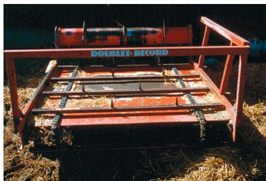
Figur 51. Bundkæden og valsen opruller rundballen. Halmen lægges i en streng til højre for maskinen.
