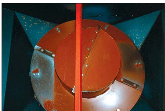
Figur 3. Antallet af knive på rotoren må ikke være for stort. Så sætter strøelsen sig fast, og motoren sætter ud.
