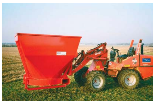
Figur 73. MS 2000 har en beholderkapacitet på 2,5 m 3 . Maskinen er selvlæssende ved at benytte beholderen som skovl.
