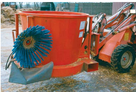
Figur 21. RIOH er monteret på minilæsser og velegnet til strøning af sengebåse.
