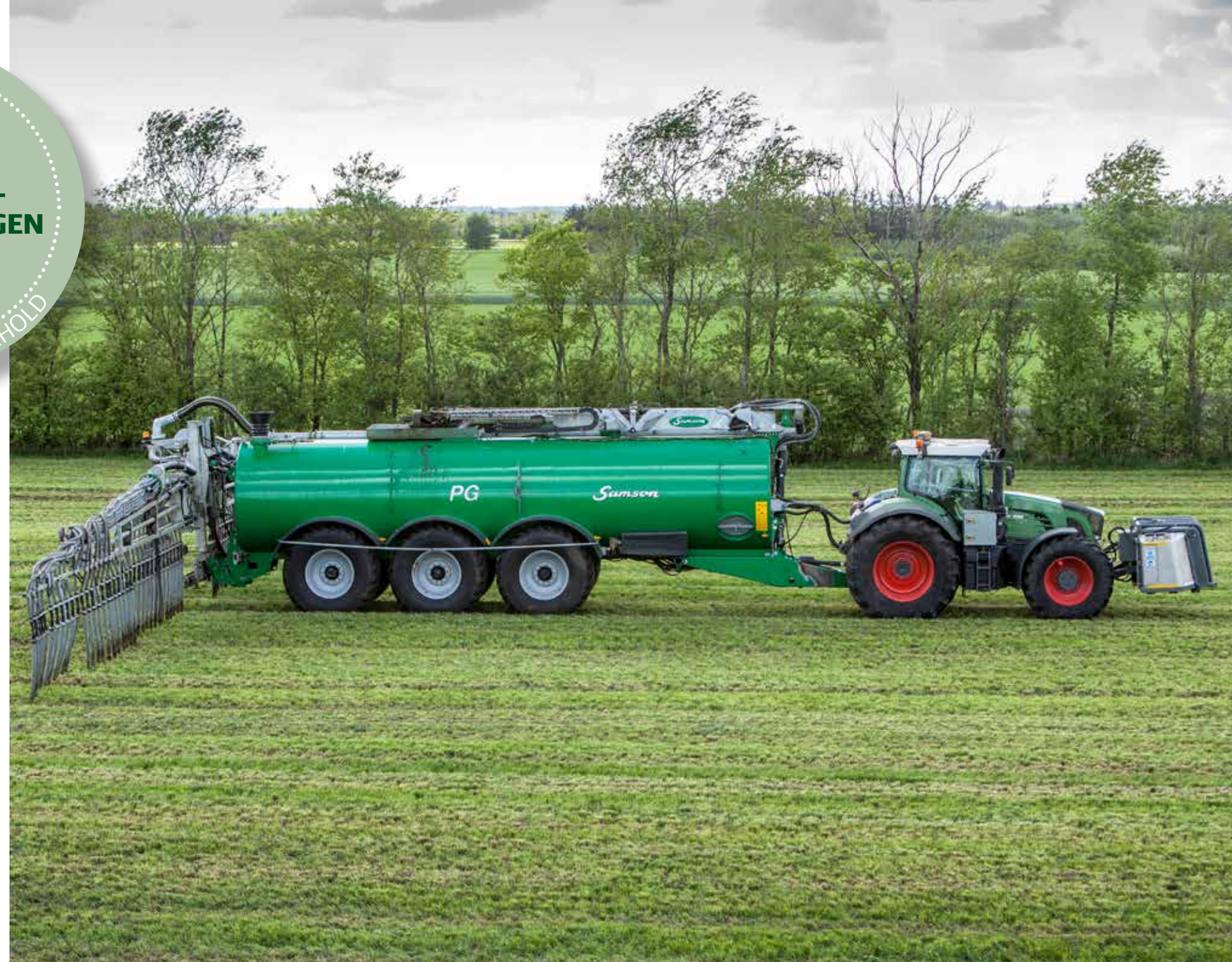
Udbringning af forsuret gylle. Syren tilføres via frontmonteret palletank. Foto: Samson Agro
