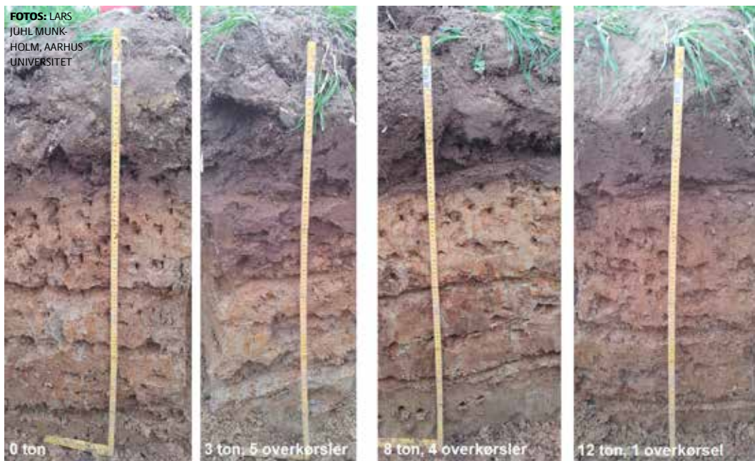
FIGUR 3. Fotos af jordprofiler fra pakningsforsøget i Årslev (0 til 100 cm).
