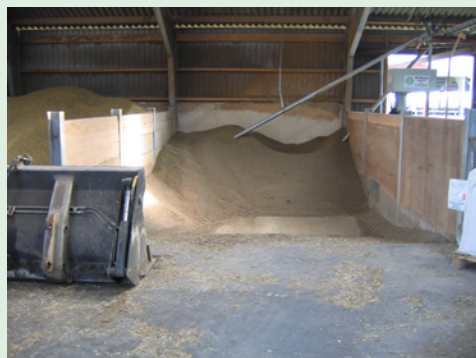
Fig. 12. Snegl fra korngrav til automatisk fodringsanlæg eller læsseområde til fuldoderblanderen.
