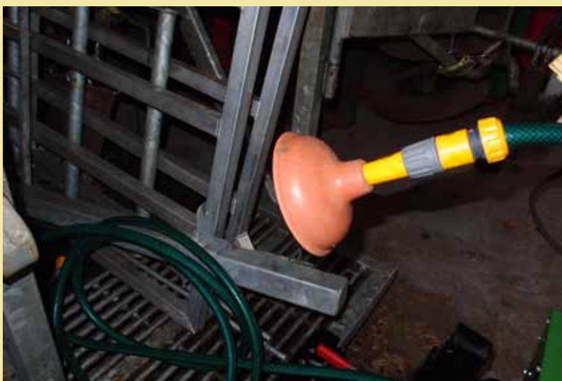
Smart spuleanordning der forhindrer vandstråler i at sprøjte bagud.
