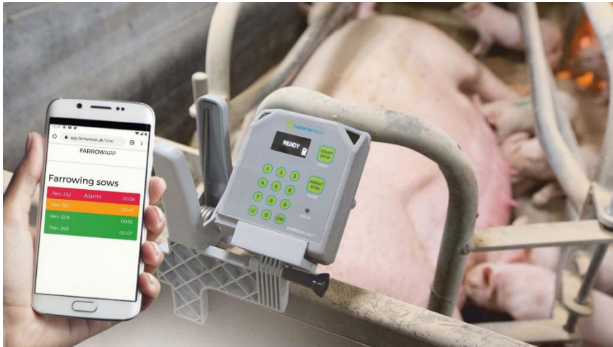
Billede 1. FarrowCam. Enheden med video, computer og sender er monteret bag soen. Faringen følges på mobilen
