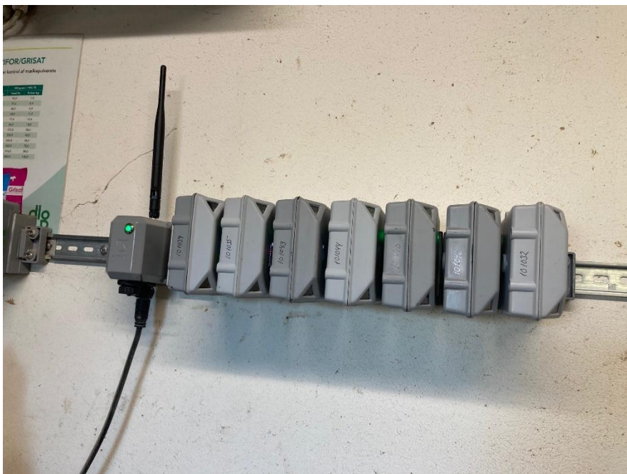
Billede 2. Ladeskinnen har radioforbindelse til enhederne, når de overvåger faringerne. Alarm fra et kamera sendes videre med WIFI til internettet, så alarmerne kan ses på en mobiltelefon
