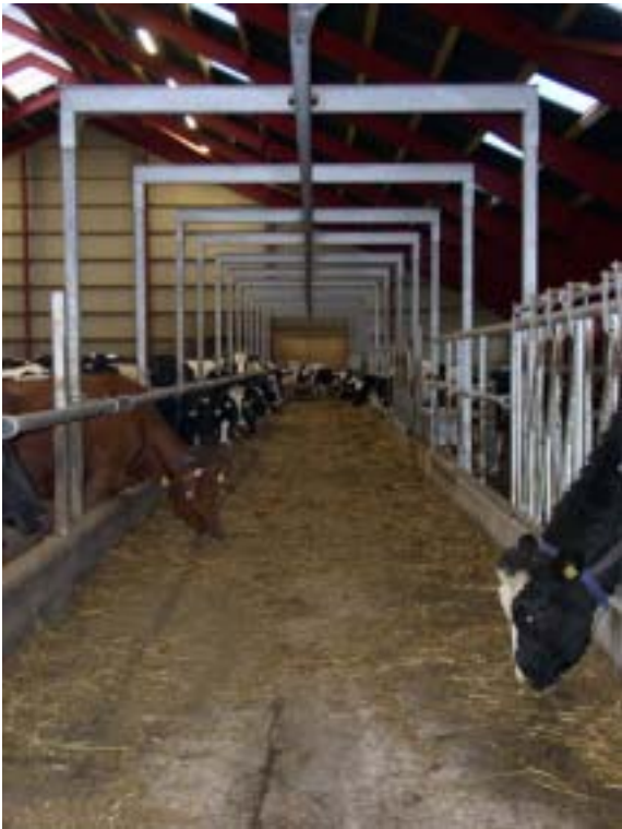
Der er foderbord i hele staldens længde. Der udfodres med en hængebanevogn.
