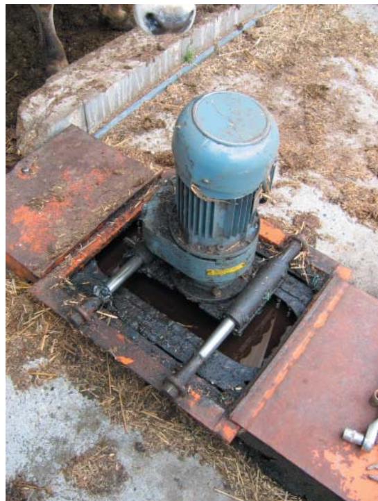
Figur 5.40 og 5.41. Fastgulvsskraberen afleverer her gyllen på spalter. El-motoren der trækker tandkranzen kører på to parallelle skinner. Det er vigtigt, at strømtilførslen er udført korrekt, så den ikke kommer i klemme når motoren kører på skinnerne.
