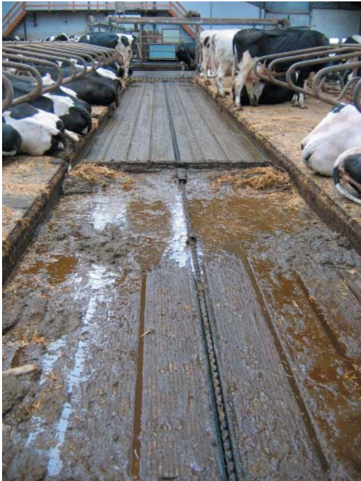
Figur 5.36 og 5.37. Fastgulvsskraberen fås både som delta- og kipskraberer. Trækstationen kan både installeres inde- og ude.
