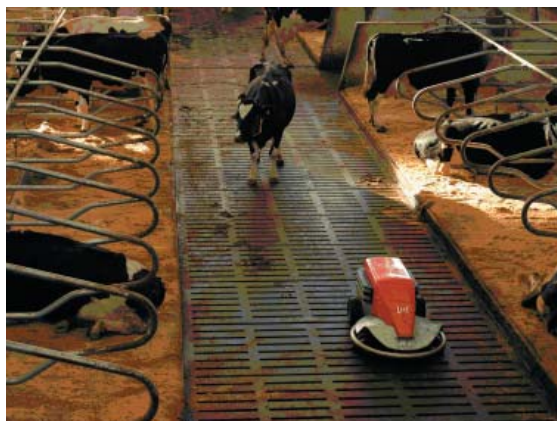
Figur 5.22. Discoveryen kan arbejde på alle typer spaltegulv. Derudover kan Discoveryen også rengøre almindeligt fast betongulv over kortere afstande (maks. 5 m). Dette kunne evt. være tværgange i stalden.
