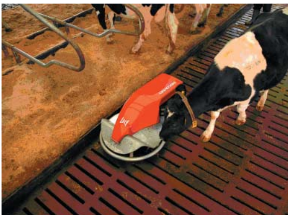
Figur 5.21. Ruten bestemmes af landmanden, og det er muligt at rengøre bestemte områder i stalden oftere. Det store horisontale hjul sikrer, at robotten følger væggen og at der afviges for forhindringer, som f.eks. stående køer eller staldens inventar.
