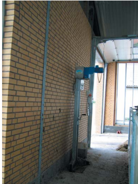
Figur 5.36 og 5.37. Fastgulvsskraberen fås både som delta- og kipskraberer. Trækstationen kan både installeres inde- og ude.
