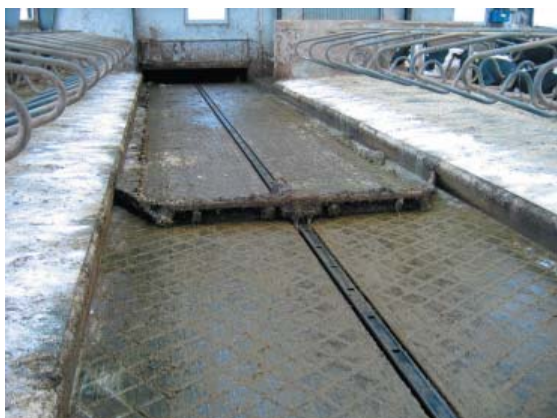
Figur 5.13. DeLaval hydraulik DM skraber på fast gulv. Skraberens driftssikker og kræver ikke meget vedligehold. Til gengæld støjer den mere end wire- og kædetræk.
