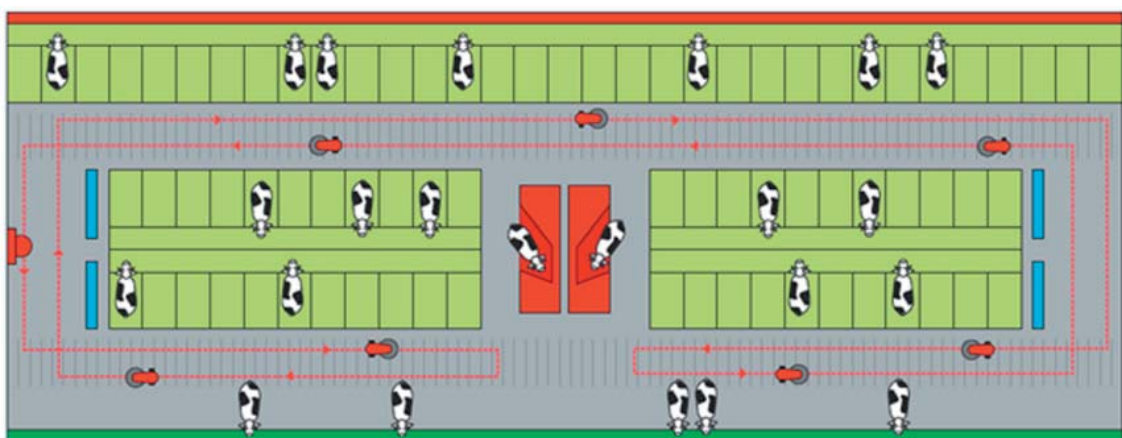
Figur 5.23. Eksempel på rute i 3-rækket sengebåsestald. Ruten programmeres med en fjernbetjening.
