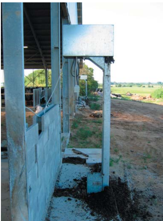
Figur 5.3 og 5.4 Trækstationen kan både placeres indenfor og udenfor. Det er vigtigt at renholde omkring stationen, idet der trækkes meget skidt med rundt. Afleveres der på spalter kan meget halm i gyllen medføre pakning.
