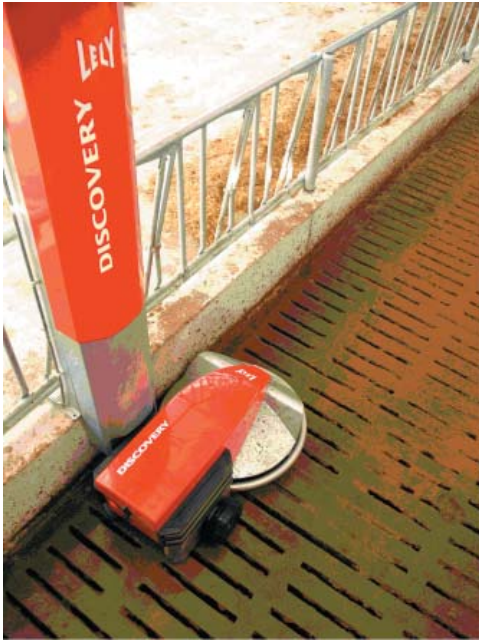
Figur 5.24. Her ladestationen med robotten parkeret. Den skal ca. tilbringe 50 % af tiden i laderen.
