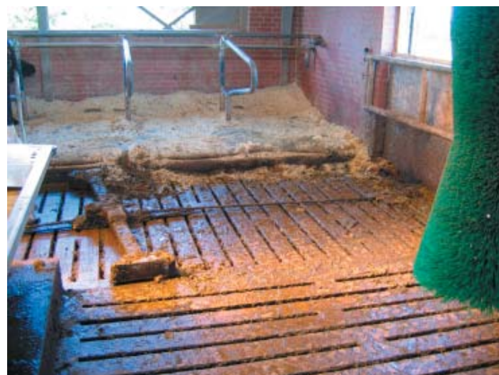
Figur 5.7 og 5.8. Samme anlæg fås med rebtræk. Princippet er billigere og lettere at reparere, men er ikke så driftssikkert og velfungerende. Bemærk på billede 5.8, at store gødningsmængder kan medføre at bommen trækker skævt.
