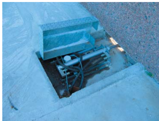
Figur 5.5 og 5.6. Brouwers hydrauliske skrbeanlæg til spaltegulv. Fremdriften sker via en hydraulikcylinder som trækkes af en elmotor. Princippet er meget driftssikkert og kræver ikke meget vedligehold.
