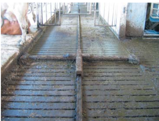
Figur 5.5 og 5.6. Brouwers hydrauliske skrbeanlæg til spaltegulv. Fremdriften sker via en hydraulikcylinder som trækkes af en elmotor. Princippet er meget driftssikkert og kræver ikke meget vedligehold.
