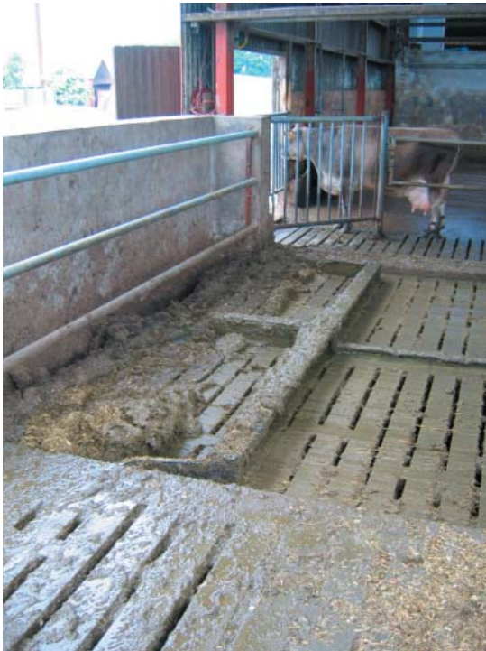
Figur 5.40 og 5.41. Fastgulvsskraberen afleverer her gyllen på spalter. El-motoren der trækker tandkranzen kører på to parallelle skinner. Det er vigtigt, at strømtilførslen er udført korrekt, så den ikke kommer i klemme når motoren kører på skinnerne.
