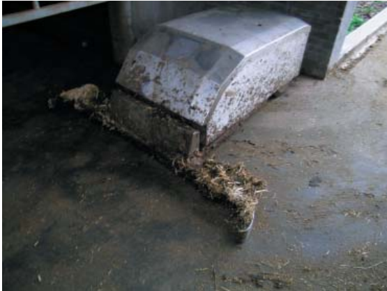
Figur 5.17. Joz har en spalteskraberobot på programmet. Robotten kan programmeres til at skrabe efter staldens individuelle indretning. Den er batteridrevet.
