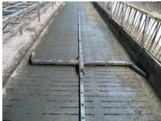
Figur 5.14 DMS modellen er et hydraulisk anlæg til spaltegulve. Bommen er mindre og udformet så den presser skidtet ned gennem spalterne.
