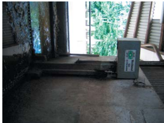
Figur 5.19 og 5.20. Kædetrækket er solidt og velfungerende. Vedligeholdet er mindre end på wiretræk men rengøring omkring trækstationen er dog vigtig at foretage jævnlige for at sikre en optimal drift.
