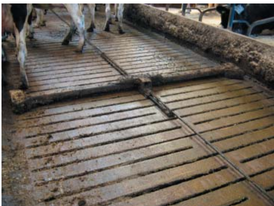
Figur 5.7 og 5.8. Samme anlæg fås med rebtræk. Princippet er billigere og lettere at reparere, men er ikke så driftssikkert og velfungerende. Bemærk på billede 5.8, at store gødningsmængder kan medføre at bommen trækker skævt.
