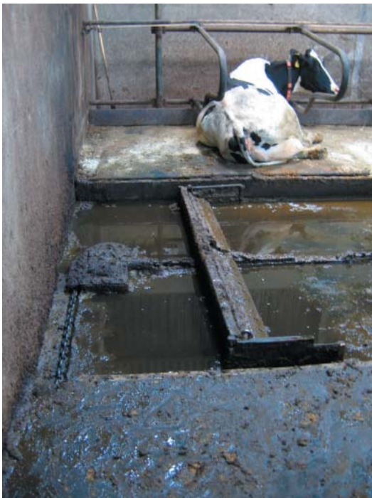
Figur 5.19 og 5.20. Kædetrækket er solidt og velfungerende. Vedligeholdet er mindre end på wiretræk men rengøring omkring trækstationen er dog vigtig at foretage jævnlige for at sikre en optimal drift.
