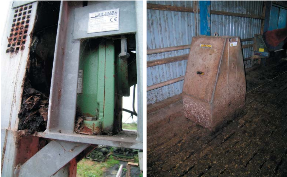
Figur 5.11 og 5.12. Spillet til kædeanlægget (tv) kræver jævnlig rengøring for at køre tilfredsstillende. Bemærk skidtet som kæden har trukket med op. Wireanlægget (th) er simpelt og billigt, men kræver mere vedligehold end kædeanlægget.
