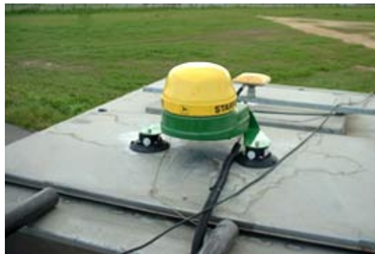
Midt på traktorens tag sad forrest på skift de GPS-antenner, der blev benyttet af guidancesystemerne. Bag denne sad RTK-GPS-antennen, der fastlægger traktorens position med få centimeters nøjagtighed.
