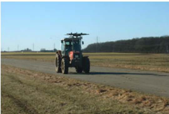
Traktoren, der blev benyttet til undersøgelsen. De første to spor var på asfalt, de efterfølgende lå parallelt hermed på en græsmark.
