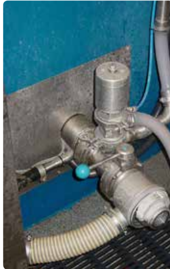
Foto 6. Eksempel på buffertankanlæg med et trykluftstyrede ventilsystem og automatisk omskift fra hovedtank til buffertank.
