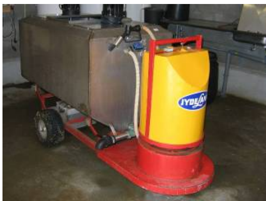
Figur 11. Mælkevogn med flow- og temperaturmåler.
