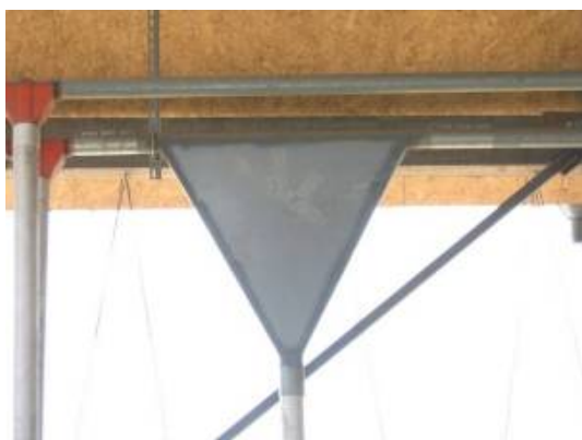
Figur 10. Smuld i kalveblandingen sigtes fra i denne smuldsigte, inden kalveblandingen snegles ud til kalvene.
