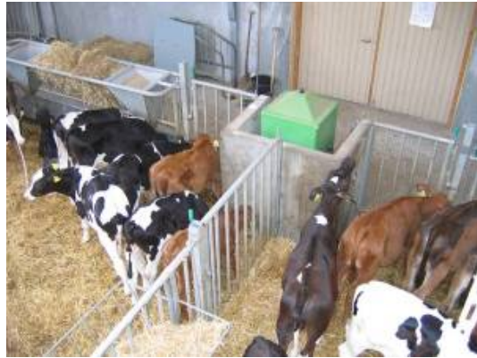
Figur 8. Mælkefodringsautomat som kan tilsluttes to drikkestationer, de sættes op på hver side af automaten hvor der er en lille låge.
