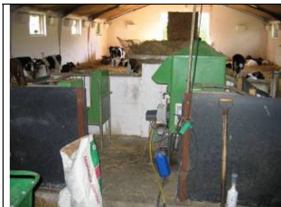
Figur 5. Mælkefodringsautomat tilsluttet fire drikkestationer.
