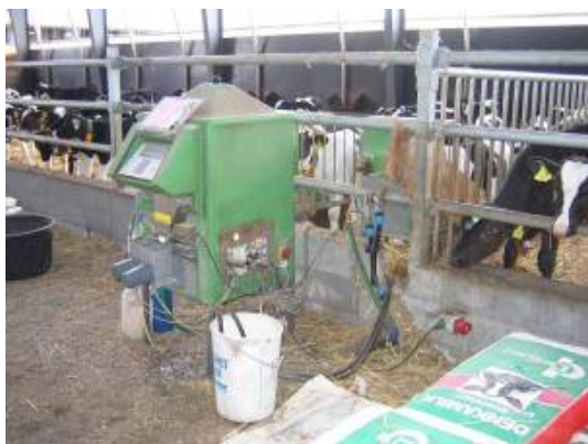
Figur 9. Mælkefodringsautomaten som forsyner de to drikkestationer.
