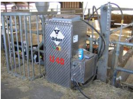
Figur 7. Mælkefodringsautomat med to drikkestationer. Automaten flyttet fra boks til boks, stativet til venstre beskytter automaten mod kalvene, når foderbordet bruges som drivgang.
