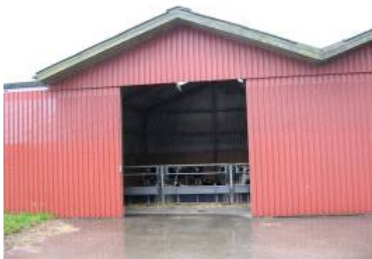
Figur 7. Luftindtag via gælleplader og åben port.
