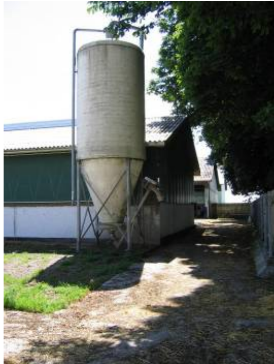
Figur 13. Silo med kalveblanding, via snegl til motorfodervogn.
