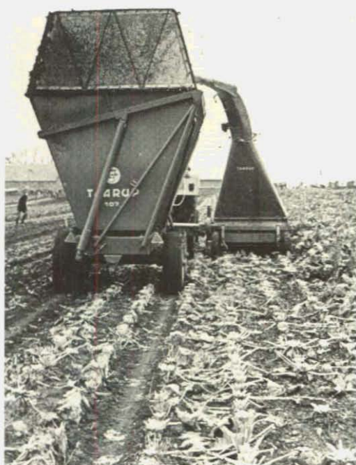
Roeaftopning i 3 rækker ad gangen. Et system der breder sig.
