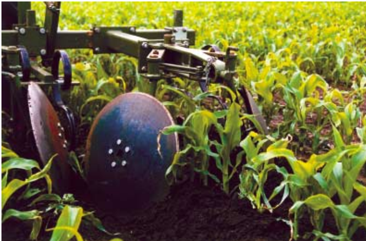
Figur 34. Skråtstillede tallerkenskær, der hypper jord ind omkring majsplanter. Foto: Danmarks JordbrugsForskning.
