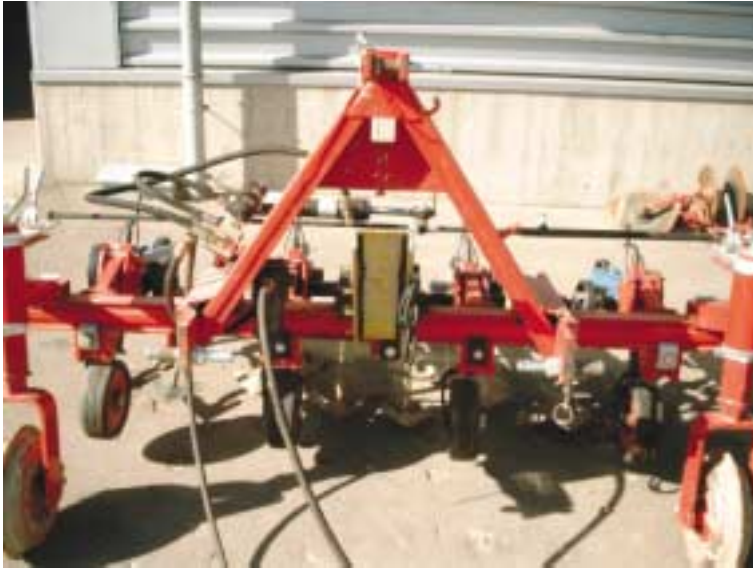
Figur 7. Ét eller to styrehjul-skiver på radrenseren, der via stangforbindelse eller individuelle hydrauliske cylindre er forbundet med det automatiske styresystem.
