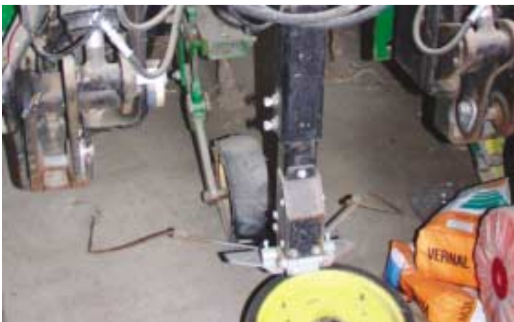
Figur 15. Styresystem med berøringsfølere.
