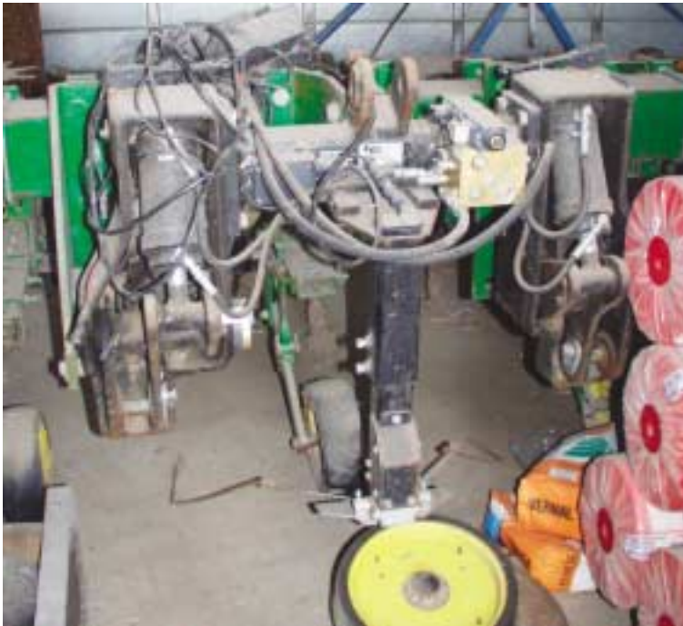
Figur 11. Individuel hydraulisk vridning af koblingsforbindelserne (trækøjerne) på traktorens trækarme.
