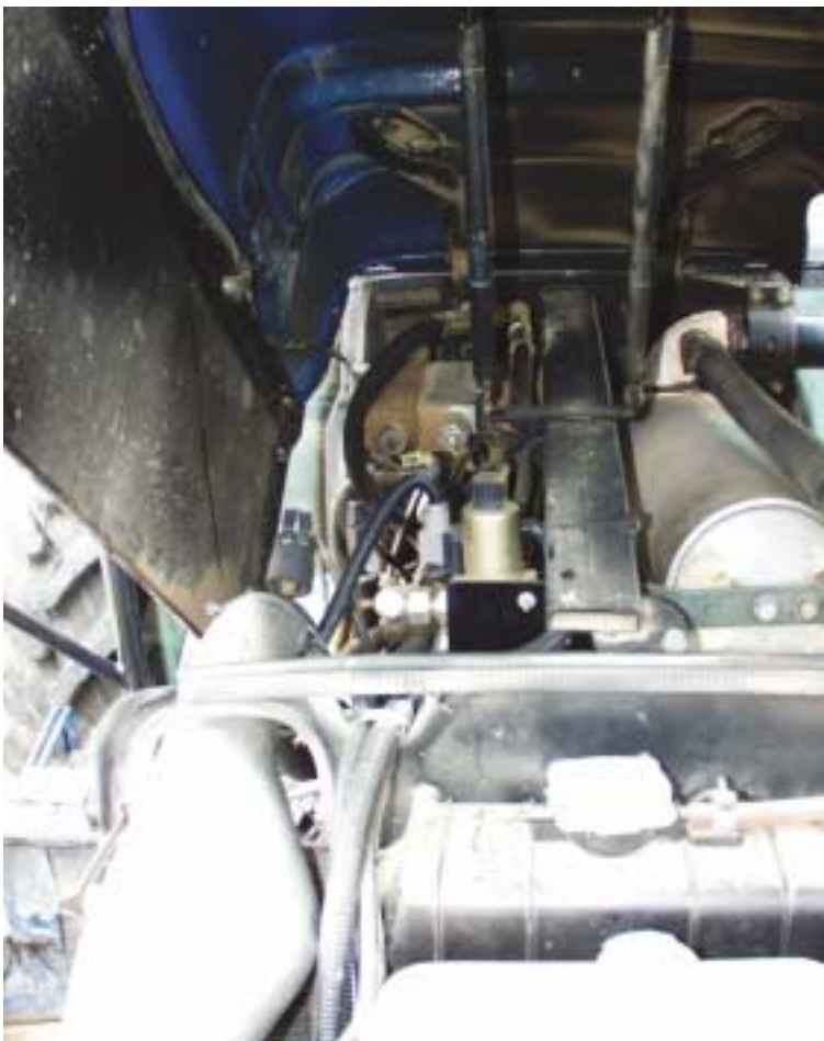
Figur 10. Styresystemet tilsluttet styrehydraulikken til traktorens forhjul.
