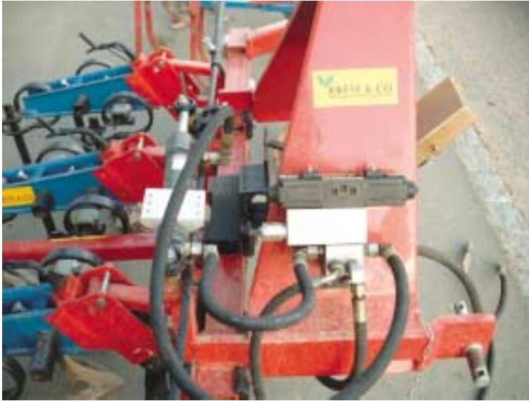
Figur 6. Autopilot systemet fra F. Poulsen Engineering.
