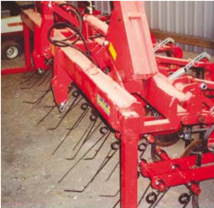
Figur 21. Skrabepinde på radrenser.
