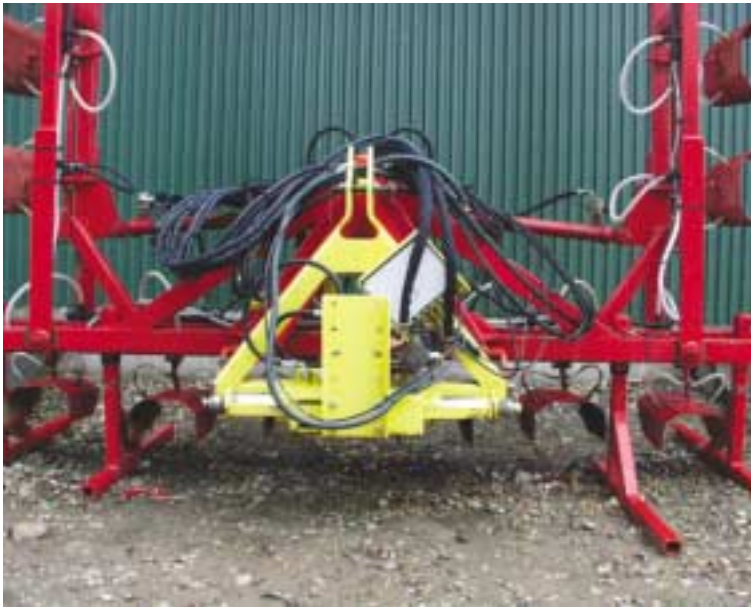
Figur 9. Hydraulisk sideforskydning af radrenseren via ramme i trepunktsophænget på traktoren.
