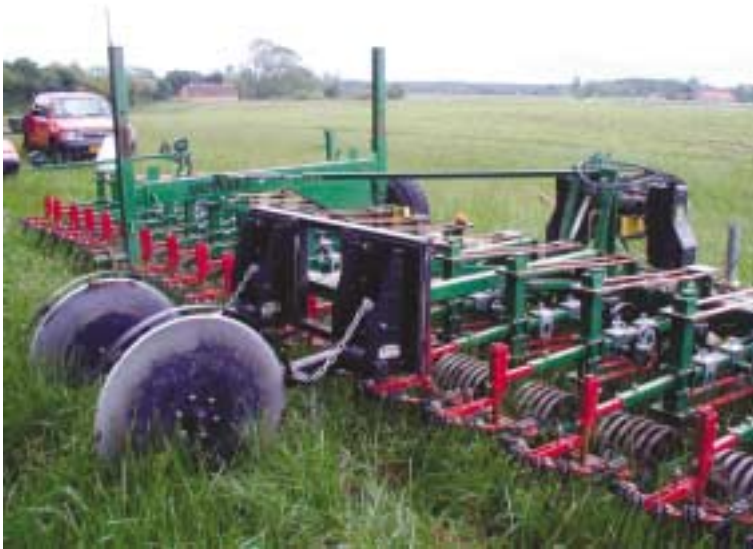
Figur 2. Kraftige stabilisatorskiver på 24-rækkers radrenser. (Udstyret med Eco-Dan styring).
