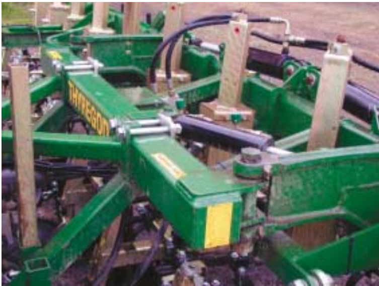
Figur 8. Hydraulisk sideforskydning af redskabsrammen på radrenseren.
