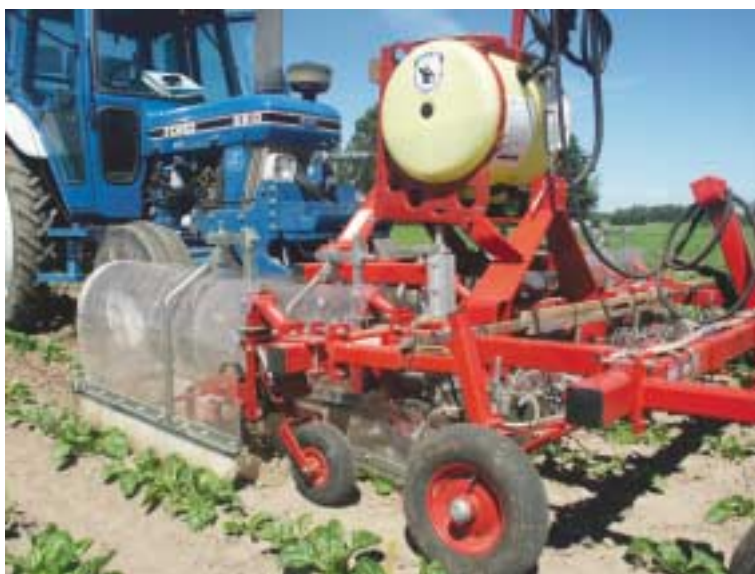
Figur 30. Støvskærme med en kant af nylonhår skærmer mellem radrensertænder og sprøjtedyser.
