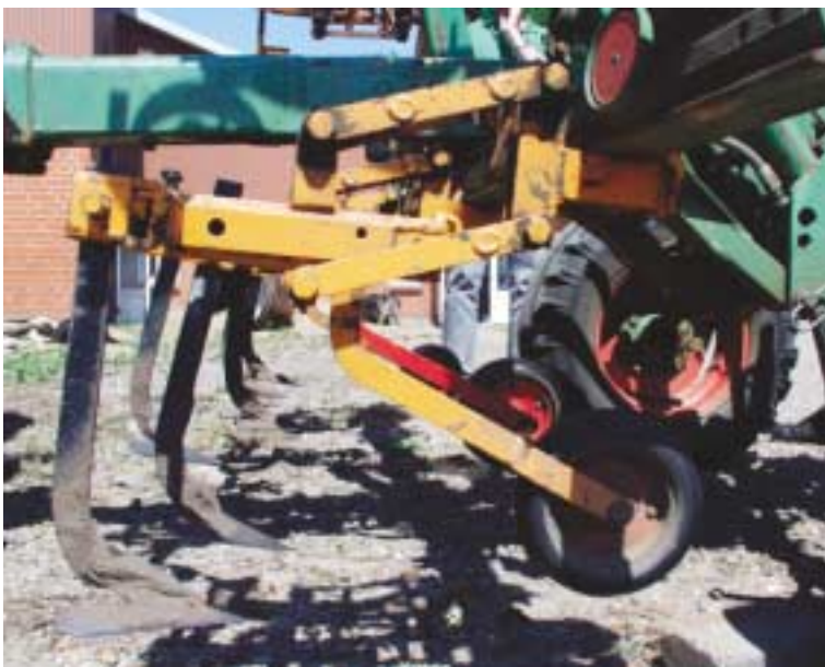
Figur 18. Parallelføring af individuel radrensersektion.
