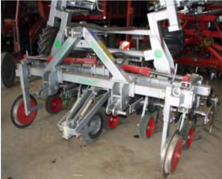
Figur 14. Radrenser med midtstillet, sfærisk skive til styring efter jordspor.
