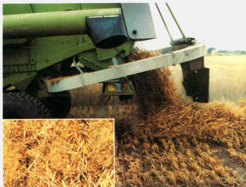
Avnetransportøren opsamler avnerne direkte fra mejetærskerens soldkasse og en kædetransportør afleverer dem ovenpå halmstrengen som vist nederst til venstre på billedet.
