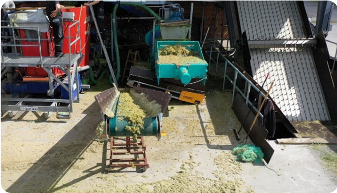
Bioraffinering til græsprotein og fiberfraktion. Foto: Martin Stoltenberg Hansen, SEGES
