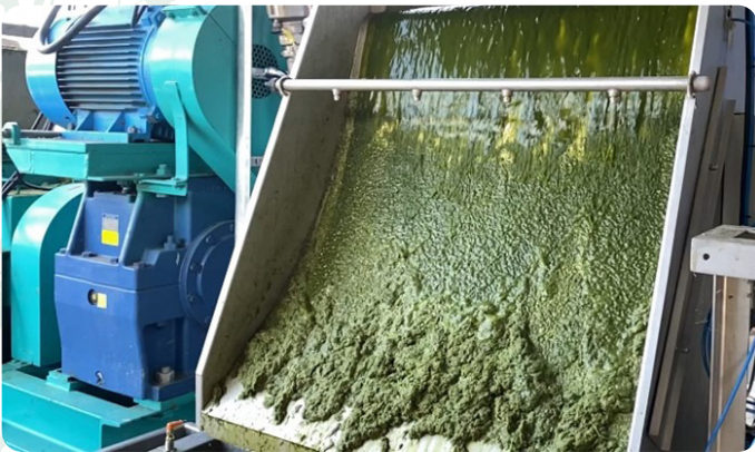
Bioraffinering til græsprotein og fiberfraktion. Foto: Martin Stoltenberg Hansen, SEGES
