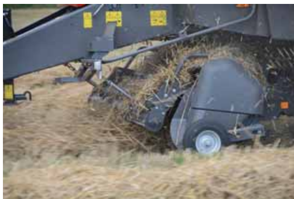
FIGUR 3 Opsamling med pickup under presning af halm. Her med presser, som har indbygget snitteaggregat.
