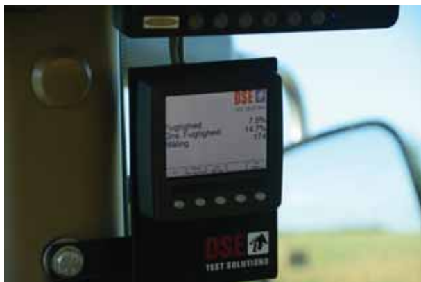
FIGUR 28 Kontinuerlig fugtmåling med mikrobølger, DSE4200 udstyr. Fotoet ovenfor, viser skærmen i traktoren. Aktuell visning er 7,5 % fugt i den nuværende balle. Gennemsnittet er 14,7 % ud af 174 målinger.
