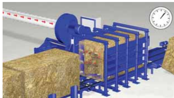
FIGUR 20 Principskitse af Ventus 2400 halmtørreriet.
