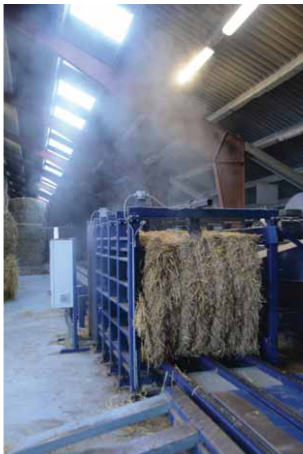
FIGUR 29 Tørring af halm, hvor dampen fra tørreprocessen stiger ovenud af tørrekommeret.
