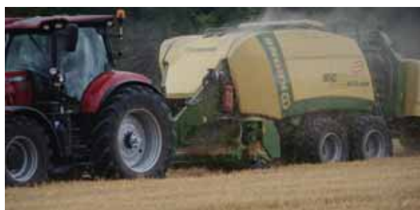
FIGUR 7 Krone 1290 HDP XC i arbejde. Selvom den viste presser var udstyret med snitter, var en 240 hk traktor tilstrækkelig til opgaven, dog kun på plan mark.
