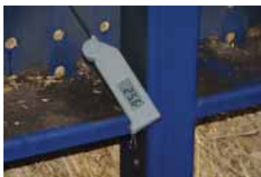
FIGUR 21 og 22 Temperaturmåling af afgangsluft under tørreprocessen. Øverst ses siden af tørrekammeret med termometeren nederst tv. Til højre ses den målte temperatur på afgangsluften.
