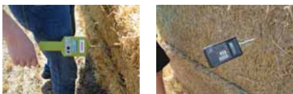
FIGUR 26 og FIGUR 27 Håndholdt fugtmålespyd – 12,4 og 18,0 % fugt
