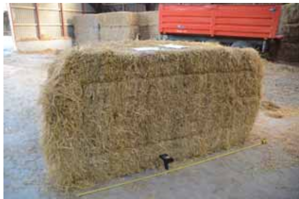
FIGUR 23 Måling af fugtprocenter i halmballe efter tørring
