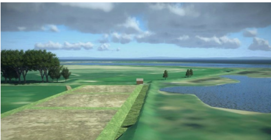
Filtermatricens placering bagved diget. Visualisering: Orbicon
