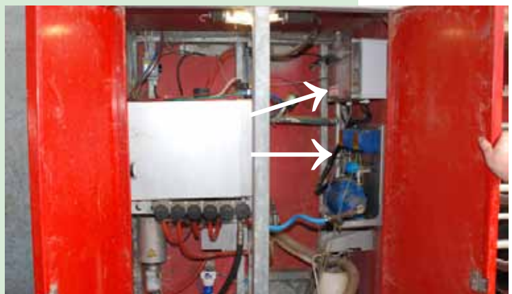
Kontrolpanel placeret i malkebobottens teknikrum
