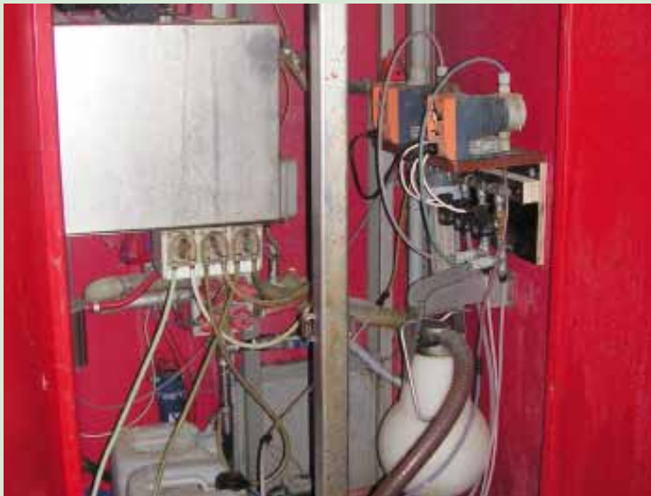
Teknikken til klovvaskeren kan installeres i malkerobotens teknikrum
