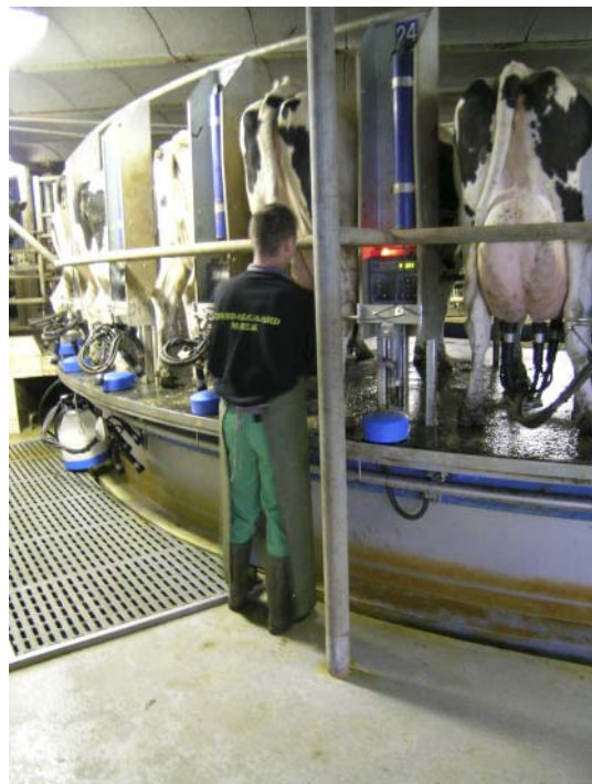
Figur 5.18. Stolper og andet inventar skal placeres, så malkeren ikke kan komme i klemme og ikke generer arbejdsrutinerne. Her er der placeret en stolpe umiddelbart ved malkerens arbejdsplads, hvilket kan være generende.
