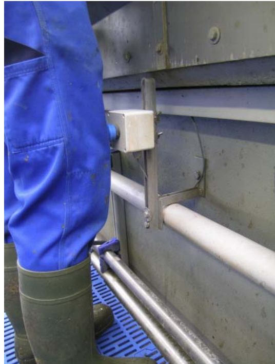
Figur 5.16. Startknap til malkesæt skal være i knæhøjde for malkeren.
