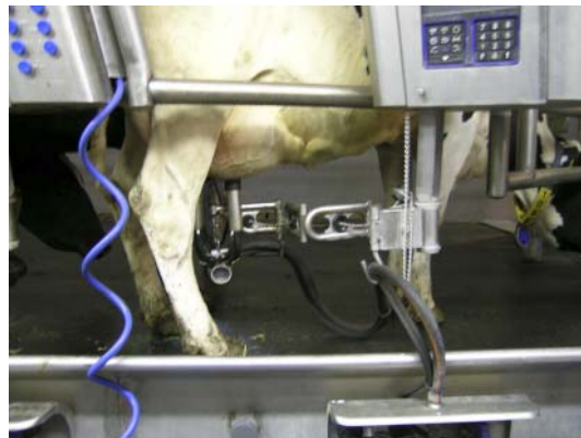
Figur 5.20. Servicearme, der bærer malkesættets vægt, kan aflaste malkeren.
