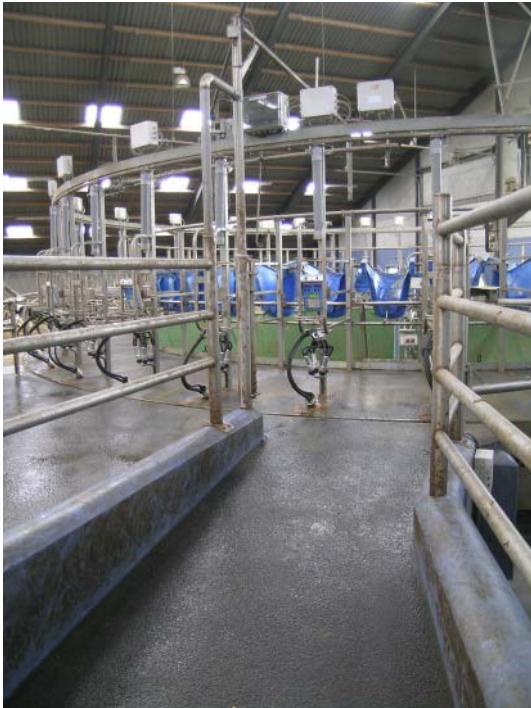
Figur 5.2. Bredt indgangsparti til platform på malkekarrusel.
