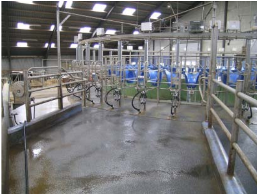
Figur 5.8. Udgang fra platform på malkekarrusel. Her er der valgt at have fire malkepladser til udgang.
