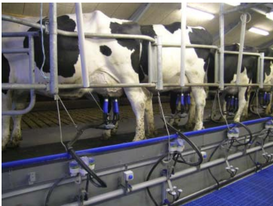
Figur 5.19. Slangestyr skal være let at indstille.
