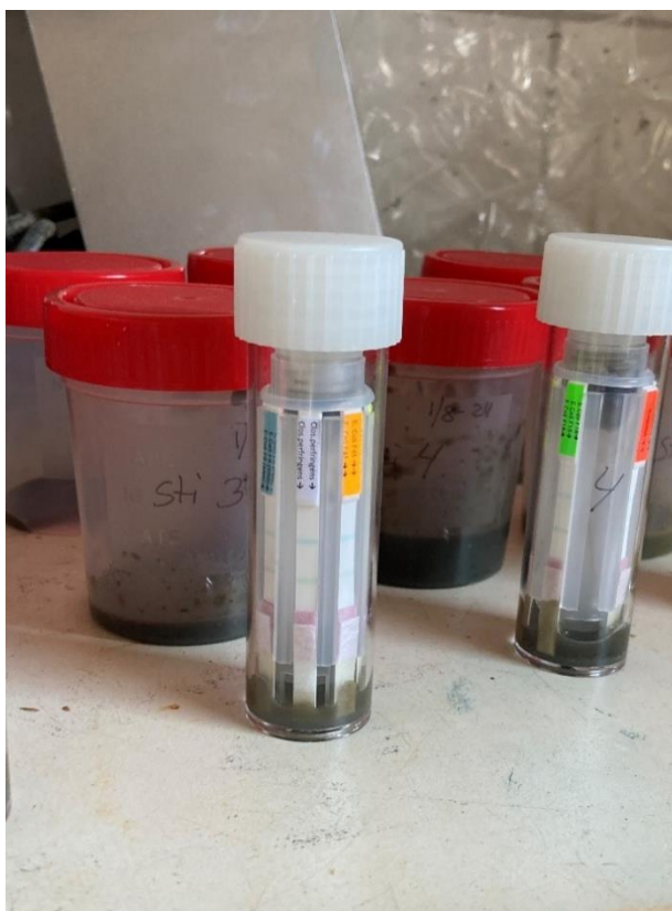
Foto 3. Testen er lige startet. Både kontrol- og teststriberne er blå, da væsken ikke har nået striberne endnu. Det lille felt viser, hvor højt væskefasen er nået op på strimlen.
