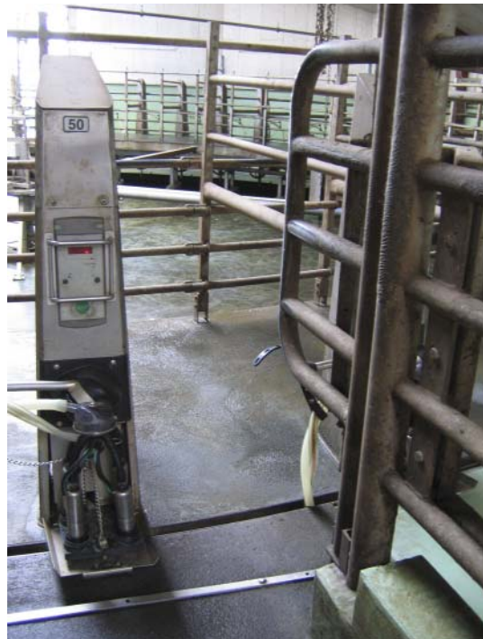
Figur 5.13. Displays ved malkepladser fra Westfalia er kun til aflæsning af data. Indtastninger er ikke muligt.
