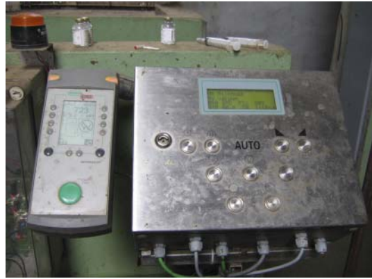
Figur 5.11. Eksempel på datadisplay til indtastning og aflæsning ved indgang til malkekarusell fra Westfalia.
