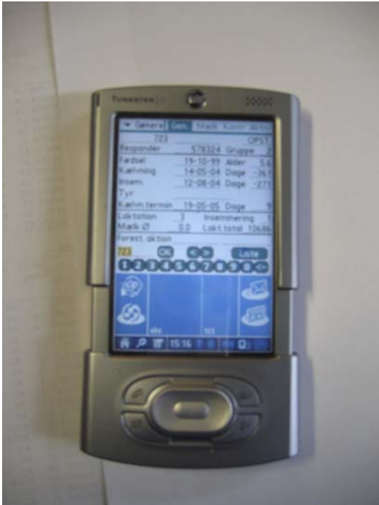
Figur 5.14. Eksempel på håndterminal fra Westfalia, mål ca. 10x15 cm.
