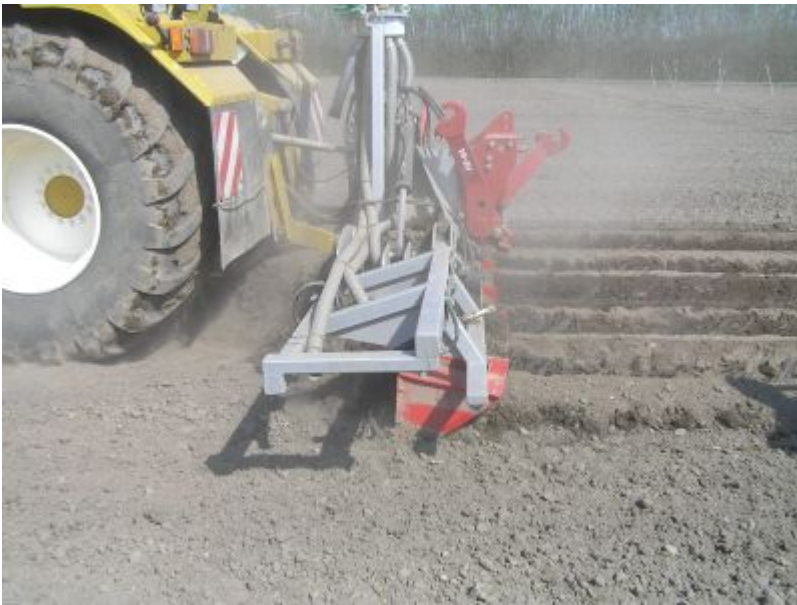
Nedfælder og kamformer arbejdede uden problemer i jorden, som var harvet i 10 cm dybde Foto:
