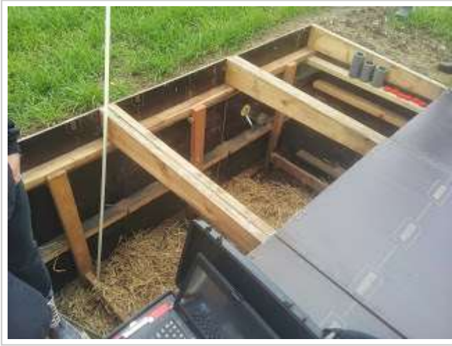
Undersøgelse af rodudvikling hos byg og olieræddike (efterafgrøde) med vandrette glaserør ved forskellige pakningsintensiteter.
