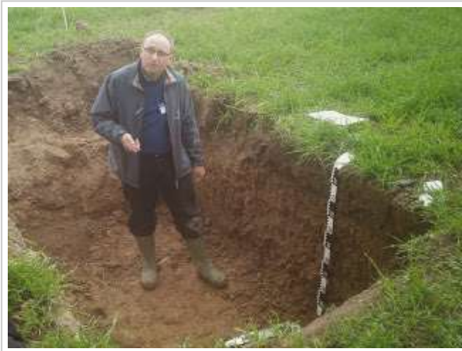
Udgravning af jordprofil til karakterisering af jordstruktur med SubVESS Flowchart
