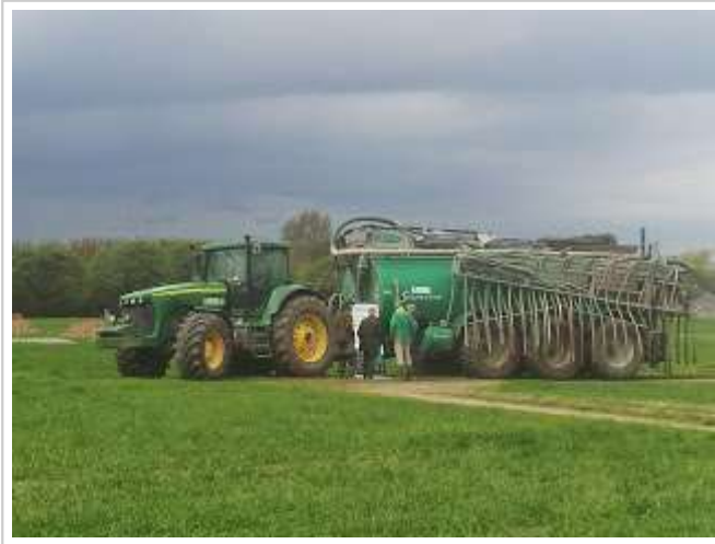
Otte tons hjullast med fem aksler (fem overkørsler)
