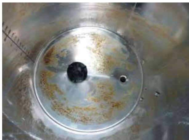
Figur 3.5. Indvendig i mælketaxa hvor renhedstest målingerne blev foretaget. Målingerne blev ikke foretaget på fastbrændt mælkefedt.
