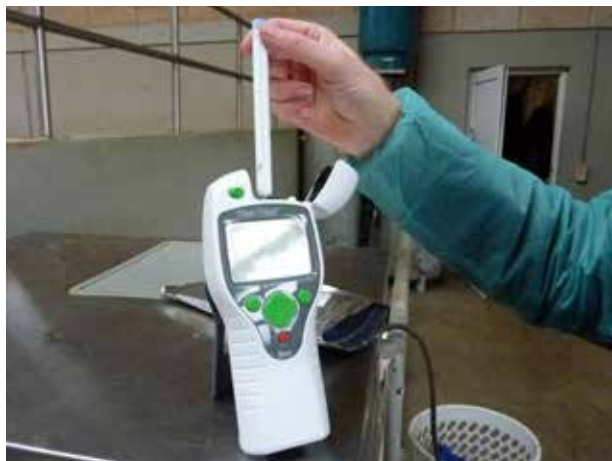
Figur 3.1. Rengøringskontrol. En svabret vatpind i hylster med enzymvæske placeres i spektrofotometer.
