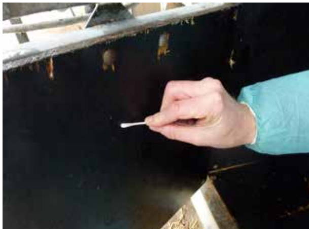
Figur 3.15. ATP måling af renheden indvendig på bokslåge.
