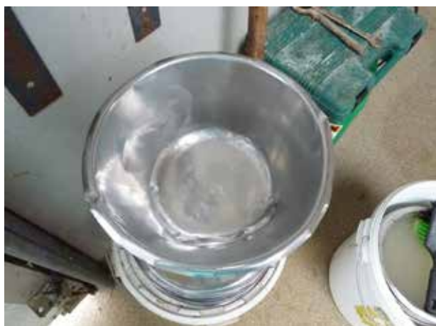
Figur 3.2. Mælkeskål iblødsat i vand og vasket med sæbe. Værdier renhedstest for to målinger: 244 og 436 – og dermed flot rene.
