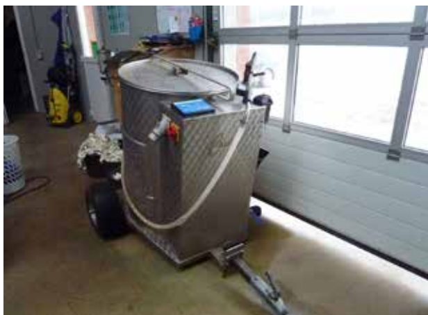
Figur 3.4. Mælketaxa her vaskes dagligt med vand (spuleslange) og en gang månedligt vaskes mælketaxaen med sæbe (tæt på månedlig vask ved besøg). Værdier renhedstest - to målinger indvendig i tank: 750.593 og 548.192. Se også figur 3.5.
