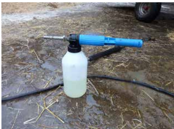
Figur 3.17. En skumpistol er velegnet til at påføre sæbe ved højtryksrensning.
