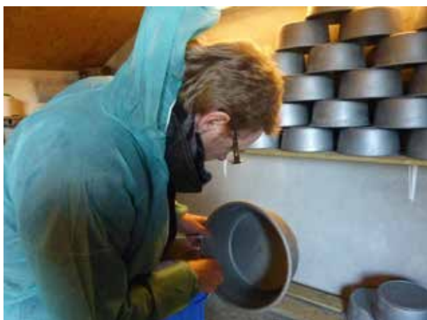
Figur 3.3. ATP målinger af plastikskål til mælk. Ikke rengjort skål: 19.412. Rengjort skål med sæbe: 58.
