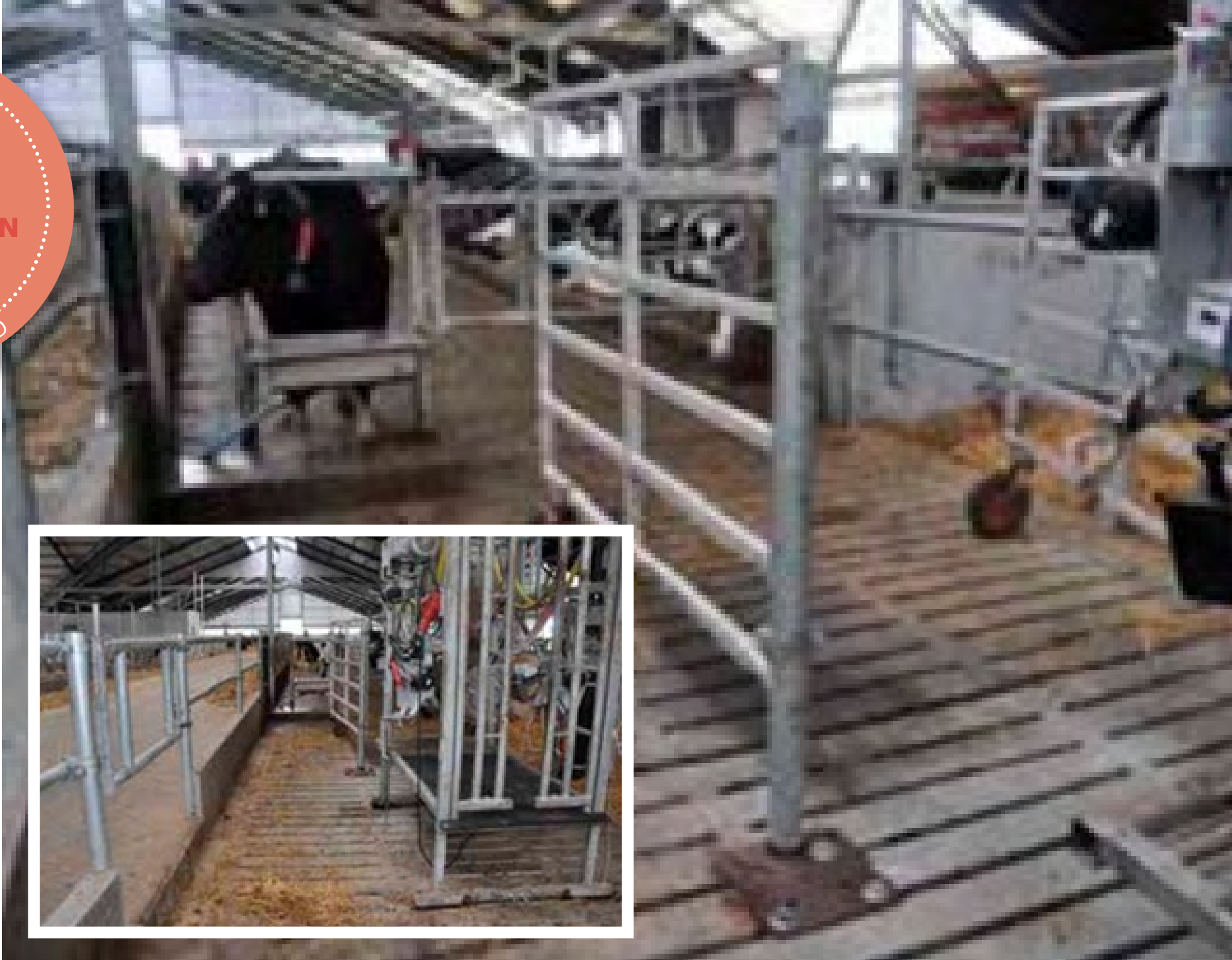
Drejbar låge til at drive koen ind i boksen (tv.) Låge i forværket giver let adgang. (Farmtest Kvæg nr. 90).
