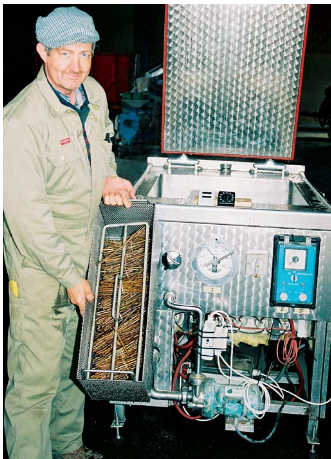
VARMTVANDSKARRET - Povl Thaysen ved det isolerede rustfrie stålkar, der er ombygget, så det kan anvendes til varmtvandsbehandling af solbærestiklinger.
