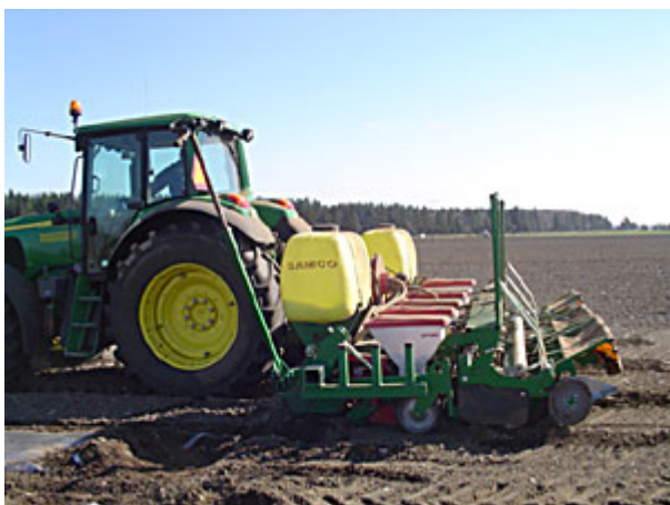
Billede 10 og 11. Såning, sprøjtning og plastdækning udføres i en og samme arbejdsgang
