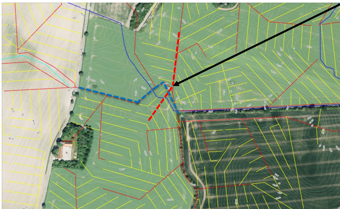
Fig. 3. Hovedledning fra de 120 hektar (rød stiplet) føres hen under eksisterende dræn fra naboarealer (blå stiplet).
