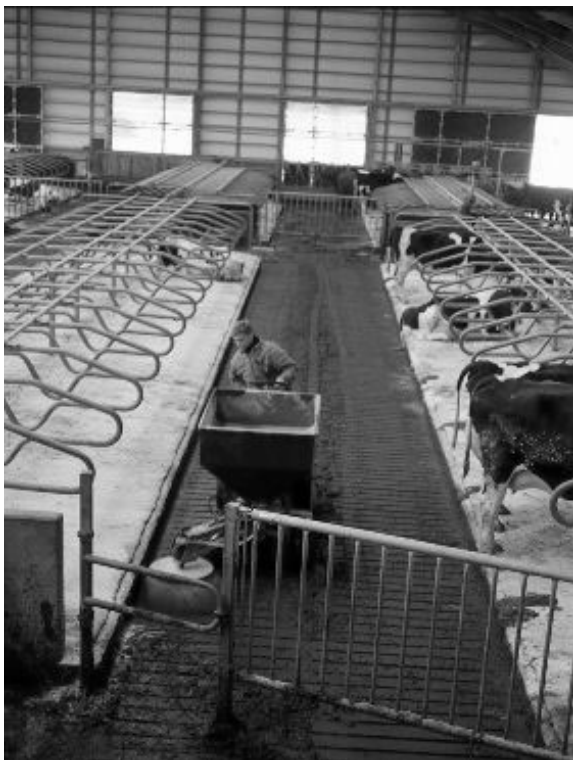
Figur 10: Strø- og fejmaskine kan feje sengebåse, feje og skrabe gangarealer med spalter, samt strø i sengebåsene.
