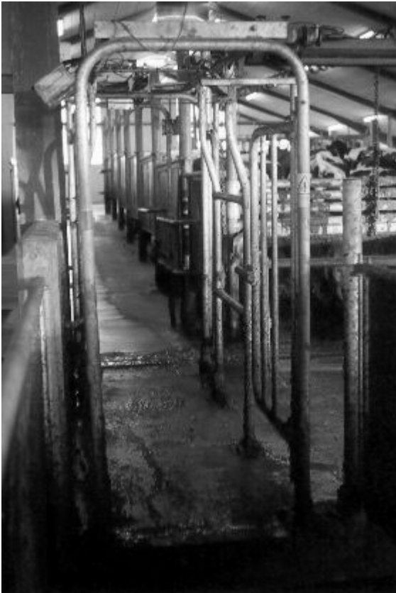
Figur 16: Identifikationsenhed til separation efter malkning.
