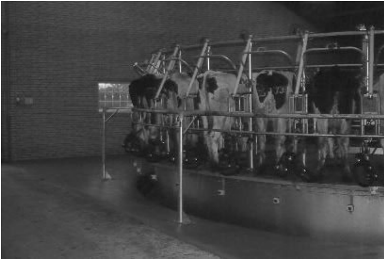
Figur 5: Malkekarrusel med udvendig malkning.
