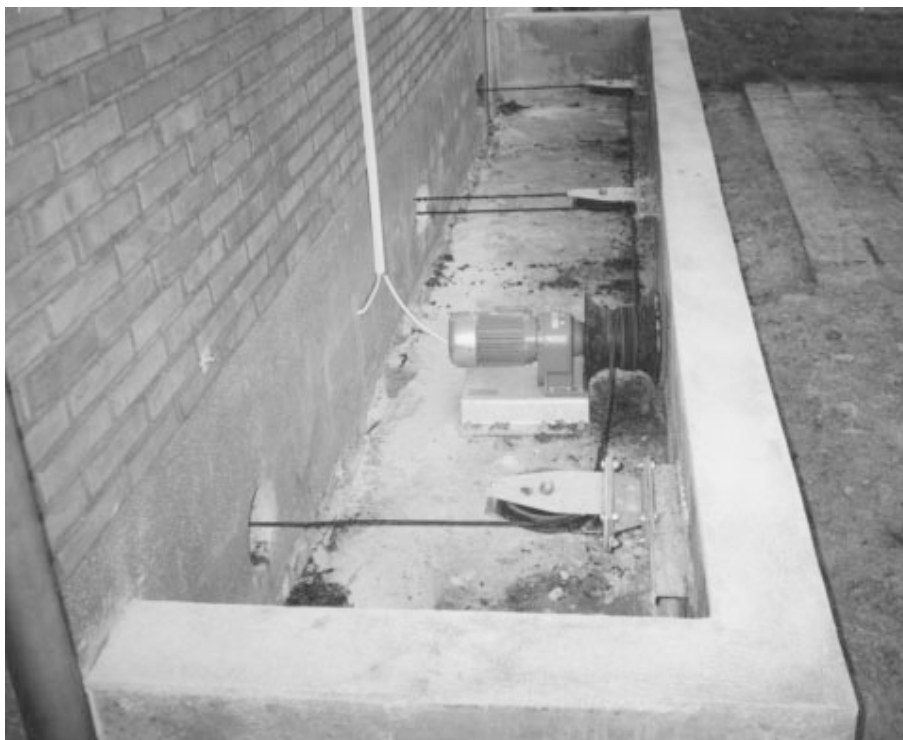
Udvendig returslag til linespilstrækstation.
