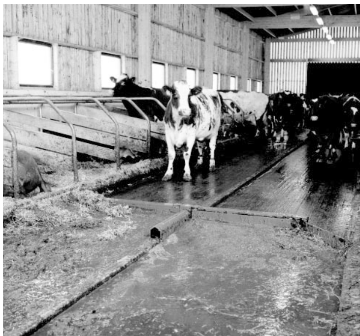
Hydraulisk skubbestangsanlæg med flapskraber
