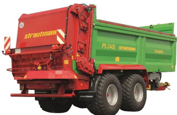
Figur 9.1: Staldgødningsspreder med spredeskiver. (Foto: Strautmann)
