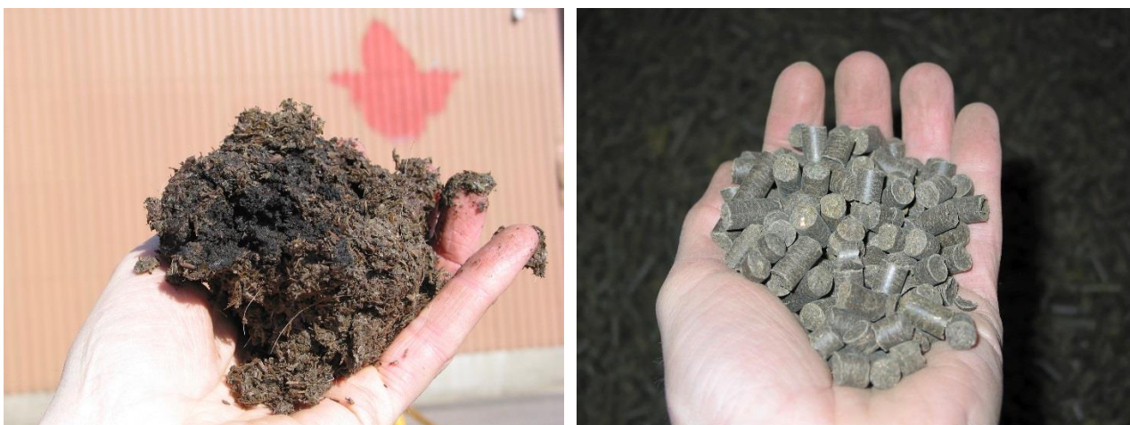
Foto af uforarbejdet fiber af dekantercentrifugeret fiber til venstre og tørrede og pelleterede fiber til højre. Foto: Torkild Birkmose, SEGES
