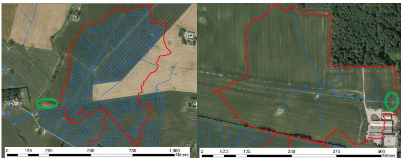
Eksempler på afgrænsning af drænoiland for henholdsvis et systemdrænet drænoiland (venstre billede) og et punktdrænet oiland (højre billede). De grønne cirkler markerer, hvor der er placeret et minivådområde.
