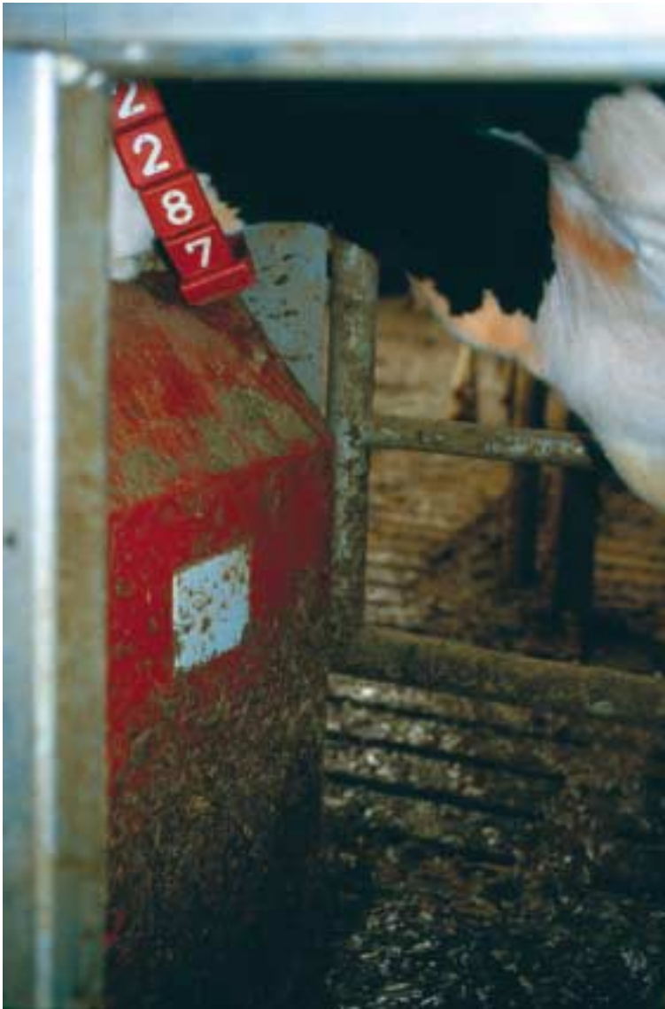
Aktivitetmåler og antenne på foderkasse i AMS-boks.
