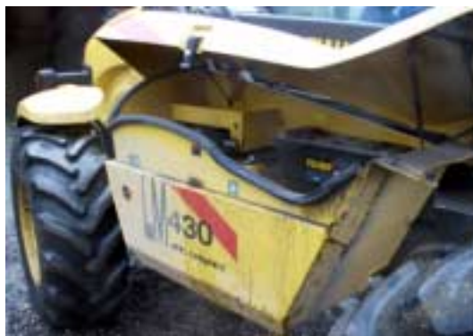
Figur 50. Adgang til servicepunkter er god, men klappen til batteriet og påfyldningssteder kan ikke åbnes tilstrækkeligt.
