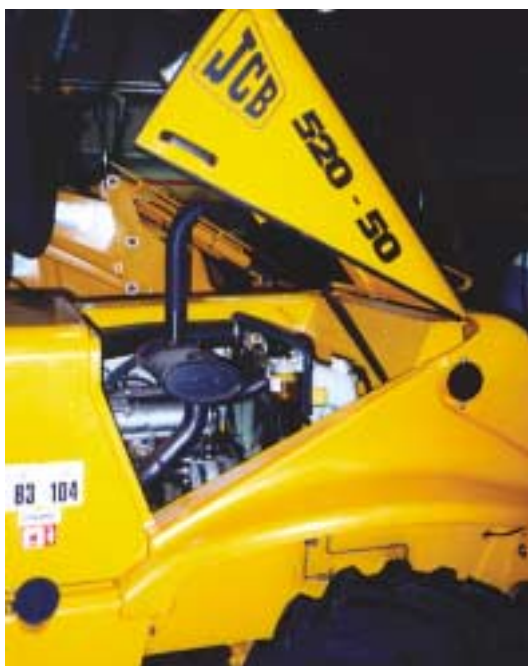
Figur 7. Adgangen til motoren er meget begrænset. Placering bag førerhuset nedsætter udsynet bagud betydeligt.
