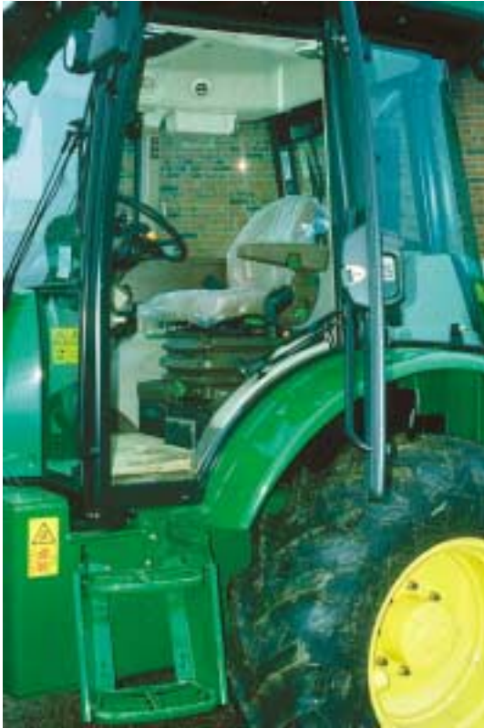
Figur 28. Ind- og udstigning er besværligt. Døren sidder for langt fremme, så man skal krænge sig ind. Sidespejlet er i vejen.
