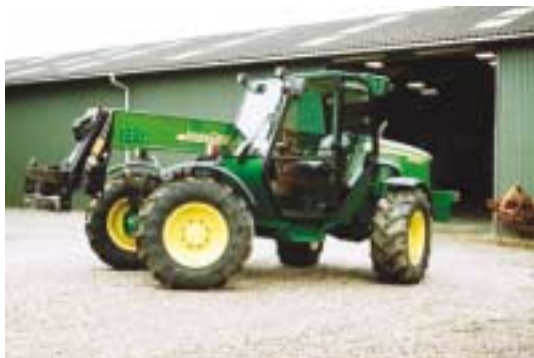
Figur 19. 3400 er den største 4-hjulsstyrede læsser fra John Deere.
