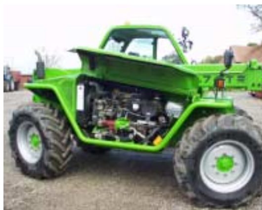
Figur 48. Motoren er placeret på siden af læsseren. Det nedsætter adgangsforholdene ved service. Adgang til de vigtigste servicepunkter er dog god.
