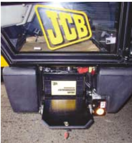
Figur 17. Batteriet er placeret under førerhuset og er let tilgængeligt.
