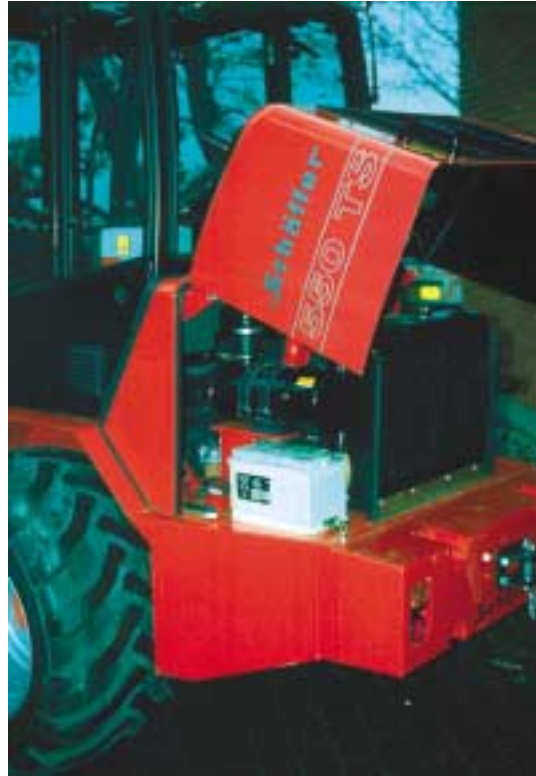
Figur 60. Adgang til motoren er ikke god. Det hjælper lidt, at der også er adgang fra førerhuset ved at løfte sædet.
