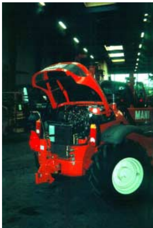
Figur 30. Adgang til motor og servicepunkter kunne være bedre.
