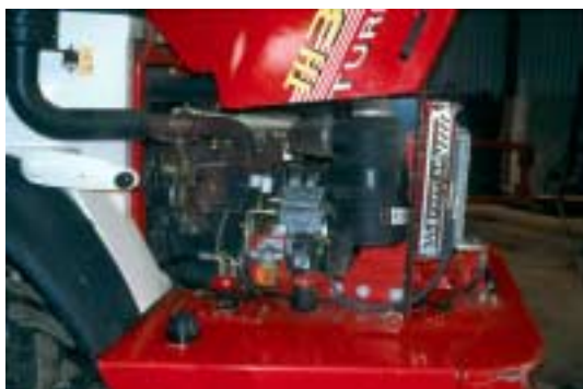
Figur 55. Adgang til motoren er god, men det kniber lidt med de øvrige servicepunkter.
