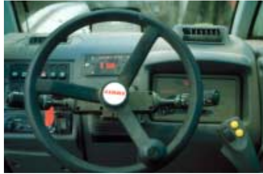
Figur 4. Instrumenteringen er ikke logisk placeret. Bemærk omdrejningstæller og dieselmåler til højre, som stort set ikke kan ses for betjeningshåndtagene.
