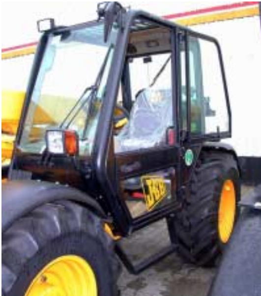
Figur 13. Ind- og udstigningsforholdene er gode, men trinbrætter er for smalt og spinkelt.
