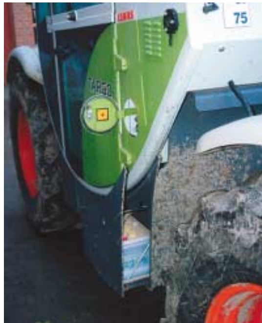
Figur 6. Adgang til batteriet under førerhuset er rimelig, men ikke imponerende.
