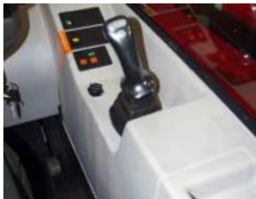
Figur 38. Joysticket fungerer fint, men der mangler et armlæn. Panelerne er udført i tynd plast.
