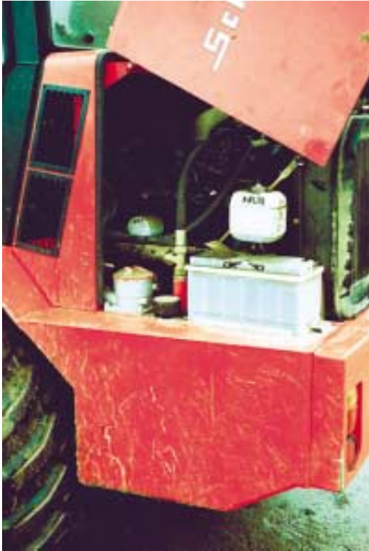
Figur 63. Motoren er svær at komme til. Servicepunkterne sidder gemt af vejen.
