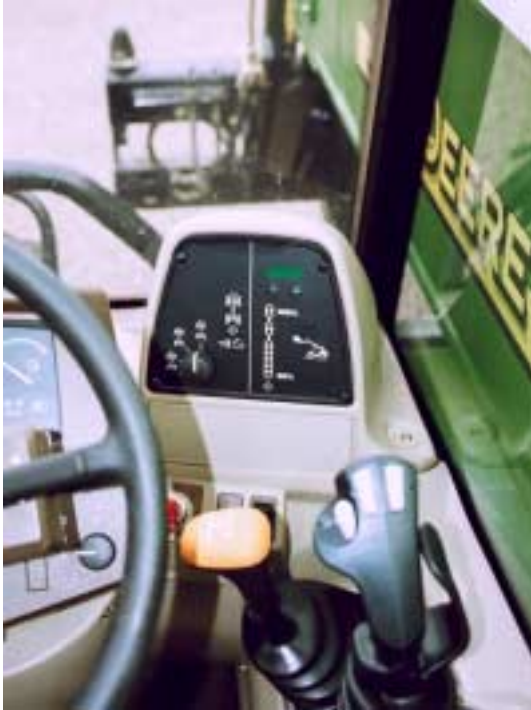
Figur 23. Gearskiftet er besværligt og går "tungt". Der er gearstang til venstre og joystick til højre. Bemærk sikkerhedsbøjlen på højre side af joysticket.
