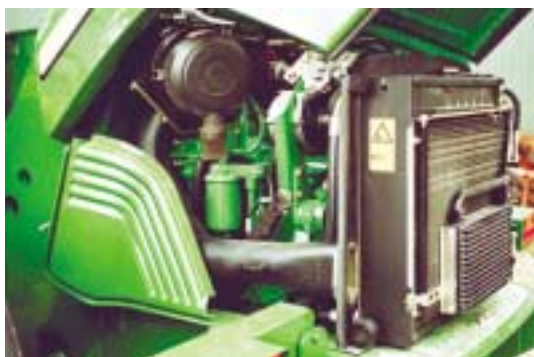
Figur 21. Motoren er støjsvag og går godt. Den er svært tilgængelig ved service.
