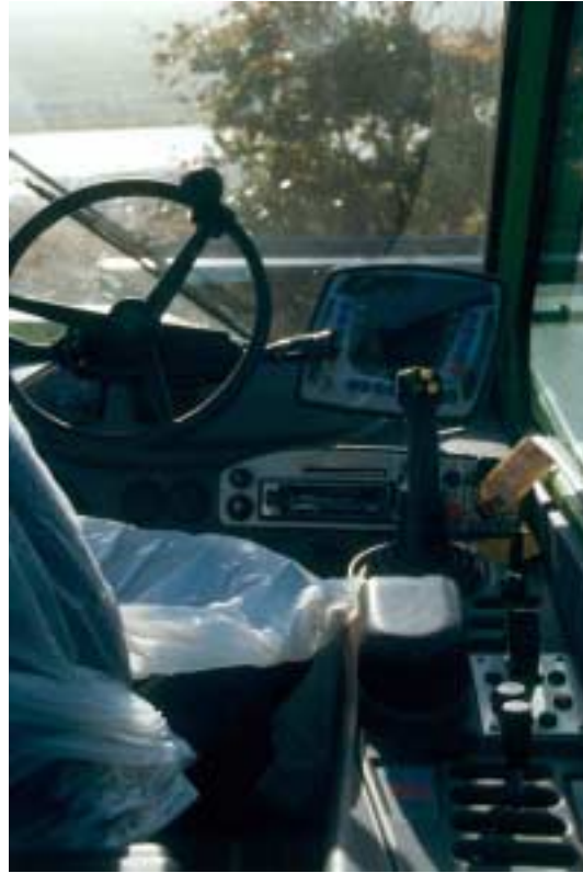
Figur 44. Al betjening af 3-punktsophæng og PTO foregår ved hjælp af kørecomputeren. Den er overskuelig og let at betjene.
