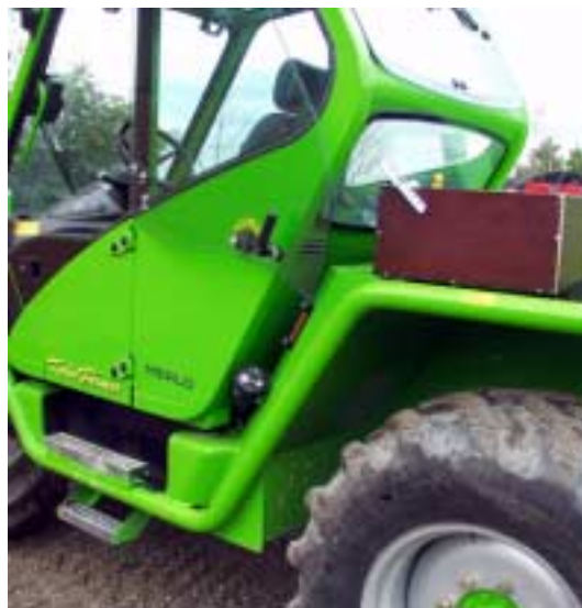
Figur 46. Udsynet bagud er dårligt på grund af den todelte bagrude. Trappen er derimod skridsikker og godt afskærmet mod skidt. Desværre er den for stejl.
