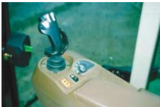
Figur 27. Joysticket er udstyret med en sikkerhedsbøjle, så man ikke aktiverer teleskoparmen ved et uheld. En god løsning, som ikke besværer brugeren.
