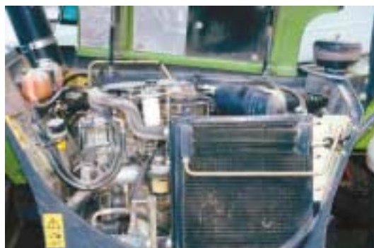
Figur 2. Motoren på K 70 leveres af Perkins. Den yder 106 hk. Adgangsforholdene til motoren er begrænsede.
