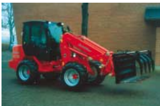
Figur 57. 550 hører til blandt de mindste knækstyrede teleskoplæssere på markedet.
