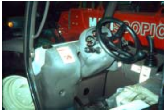
Figur 32. Ind- og udstigningsforholdene er gode, selv om læsseren er lille. Joysticket fungerer fint.
