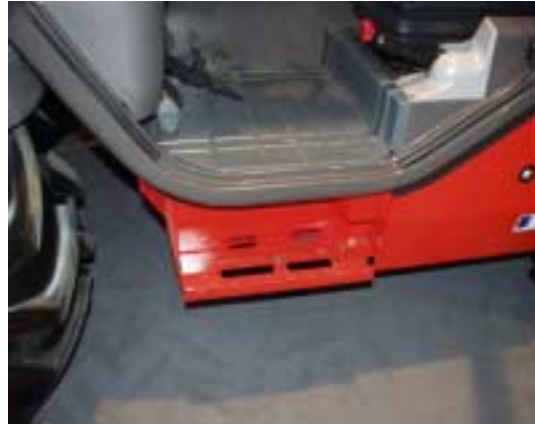
Figur 36. Trinbrættet er for lille. Den manglende afskærmning til forhjulene vil medføre, at det hurtigt bliver meget beskidt. Bemærk den brede bremsepedal.
