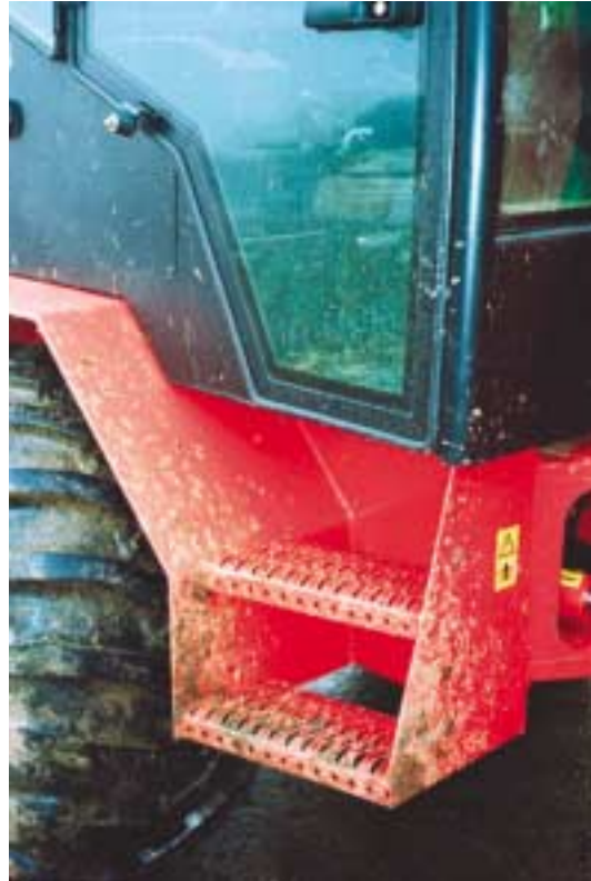
Figur 64. Ind- og udstigningsforholdene er gode på læsseren. Trappen er bred og skridsikker.
