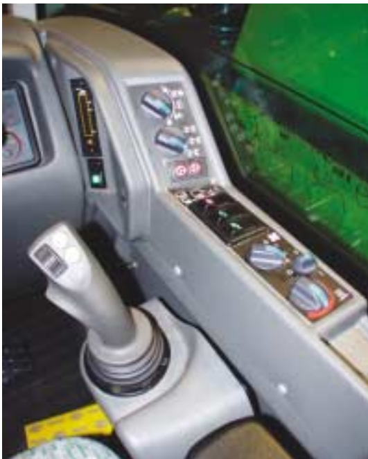
Figur 5. Joysticket virker spinkelt og billigt, men fungerer fint. Specielt det lille drejhjul, som styrer ind- og udskydning af teleskoparmen, er en god detalje.
