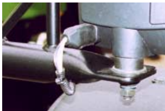
Figur 22. Finishen er generelt god, men der er mindre fejl som for eksempel isolering af ledninger.
