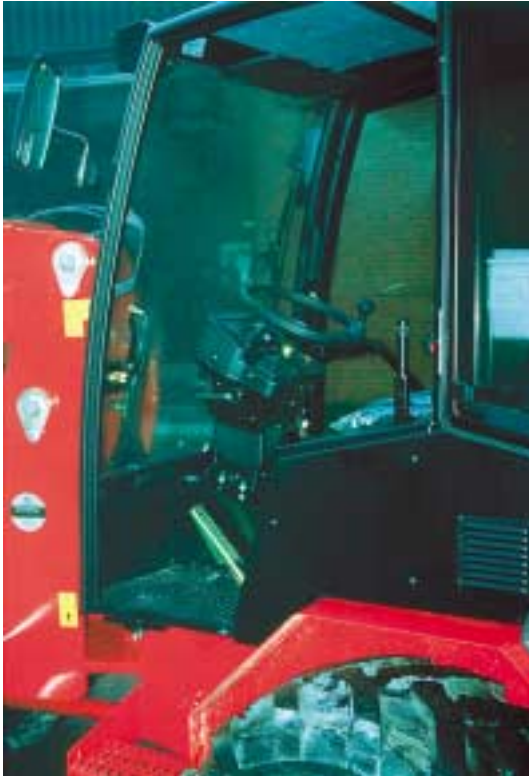
Figur 59. Ind- og udstigningsforholdene på 550 er gode. Man skal ikke krænge sig ind som på andre knækstyrede læssere.
