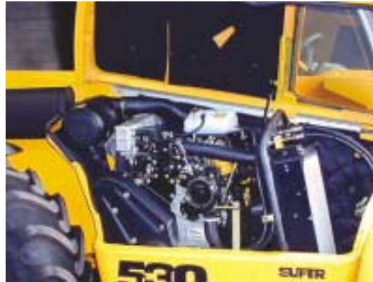
Figur 16. Servicepunkterne er let tilgængelige. Motoradgangen er begrænset. Selve motorrumskassen kan afmonteres.
