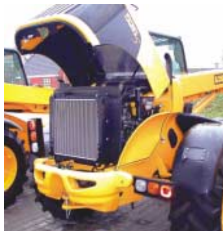
Figur 12. Adgang til motor og servicepunkter er gode.
