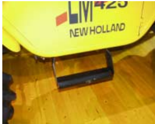
Figur 52. Trinbrættet er spinkelt bygget og ikke tilstrækkeligt skridsikker. Det bliver hurtigt beskidt på grund af dårlig afskærmning fra forhjulene.
