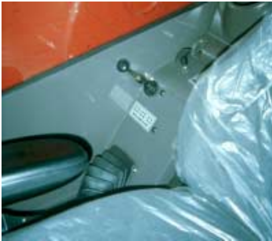
Figur 31. Gearskifte og skift mellem hjulstyring er gemt af vejen under armlænet.
