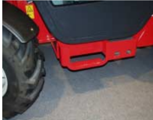
Figur 40. Trinbrættet er meget smalt og ikke tilstrækkeligt skridsikkert.
