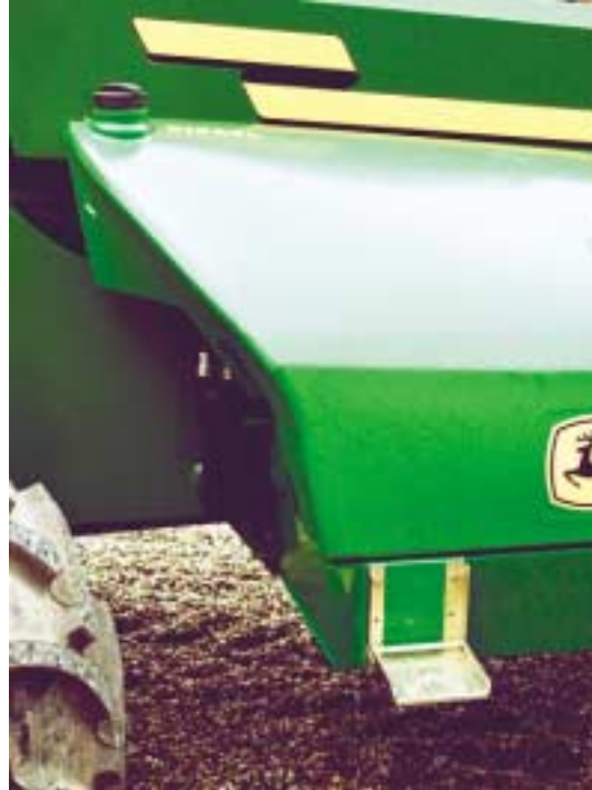
Figur 24. Tankdækslet er dårligt placeret. Man har forsøgt at afhjælpe problemet med et lille trinbræt.
