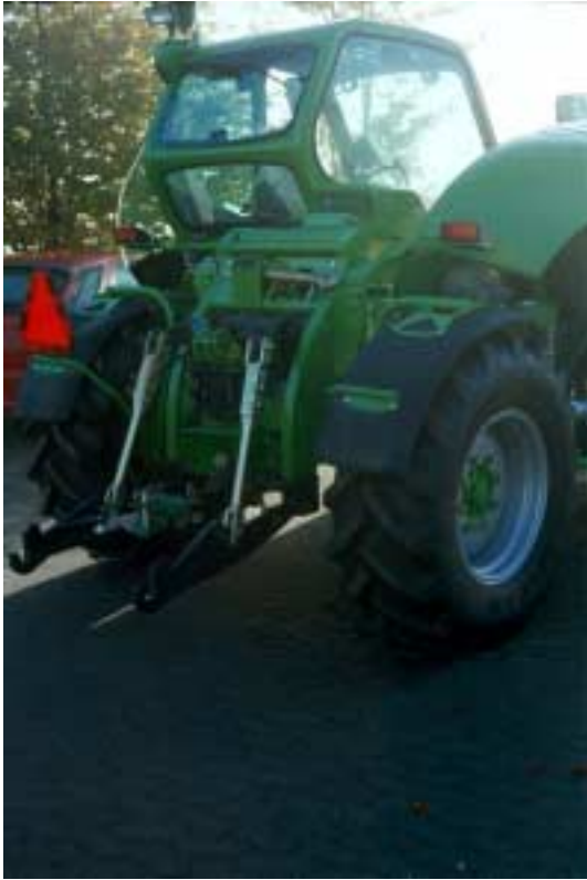
Figur 43. 3-punktsophænget, som kan løfte 4.300 kg. Bemærk bjælken i den todelte bagrude, som nedsætter udsynet bagud.
