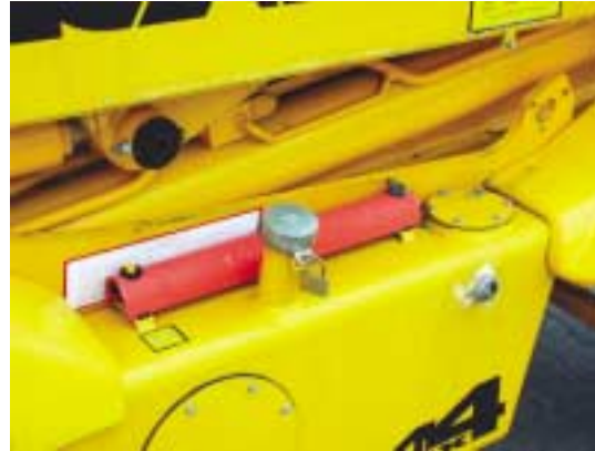
Figur 10. Finishen er ikke i top på 520. Der er flere uheldige løsninger som for eksempel hængelåsen på dækslet til påfyldning af hydraulikolie. Låsen er påsat af sikkerhedsmæssige årsager.
