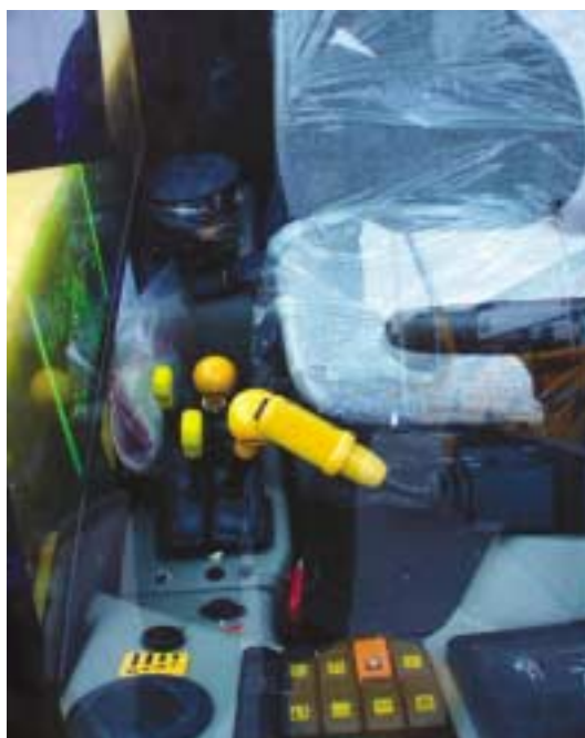
Figur 8. 520 betjenes med håndtag. Det fungerer fint, men er ikke så hurtigt og brugervenligt som joystick.
