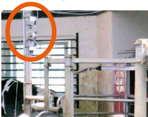
Billede 9. Måleudstyr placeret ca. 1 meter over køerne.
