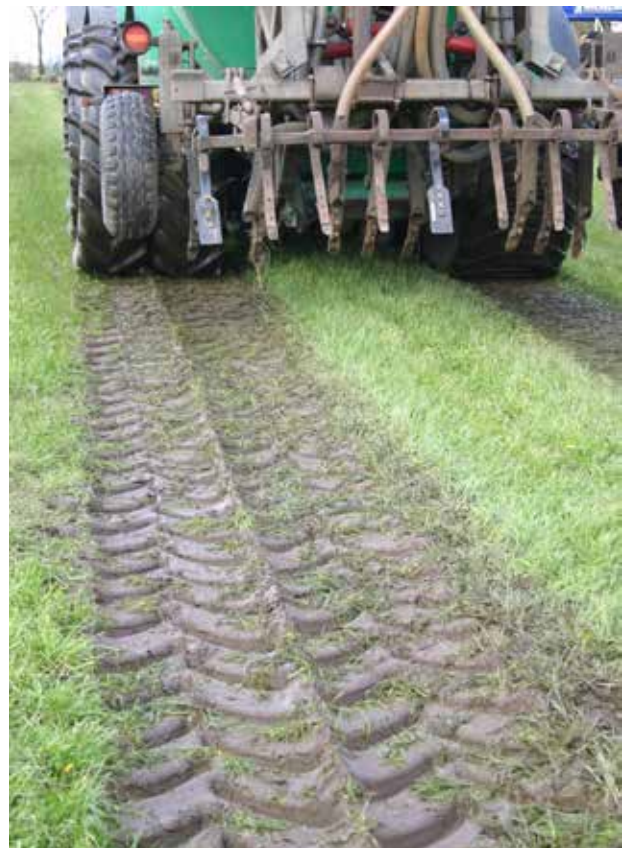
Det er velkendt, at dæktryk og hjullast begge har betydning for jordpakning. Der skal derfor tænkes i nye baner for at fordele vægten bedre. Foto: Janne Hansen
