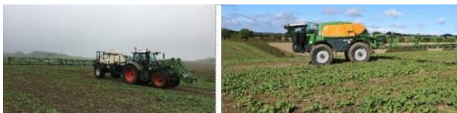
Foto 1. Til venstre ses MGM trailersprøjten, der for ca. 20.000 kr. er blevet opgraderet til præcisionsjordbrug. Til højre ses den selvkørende Amazone Pantera.
