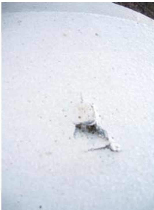
Figur 5 og 6 - "Calf-O-Tel lille" er stabil under normale danske vejrforhold, men ved storm kan den vælte rundt, og der opstår skader som revner og huller.
