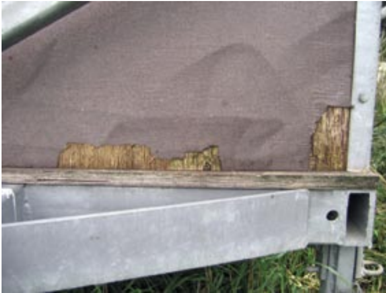
Figur 3 - Udvendig afskalling på "Mobilkalvevognen".
