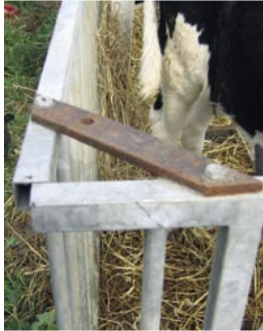
Figur 6 - Hjemmelavede jernstykker til erstatning for plasthjørner.
