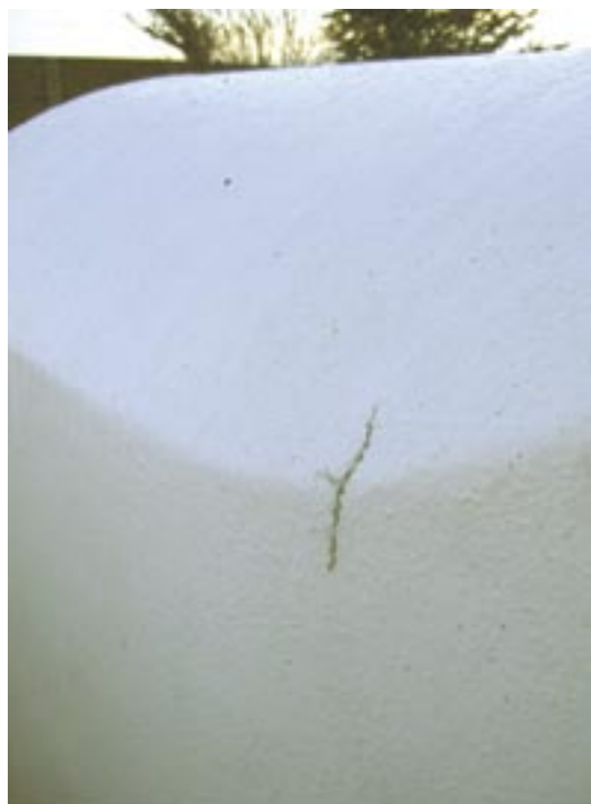
Figur 5 og 6 - "Calf-O-Tel lille" er stabil under normale danske vejrforhold, men ved storm kan den vælte rundt, og der opstår skader som revner og huller.
