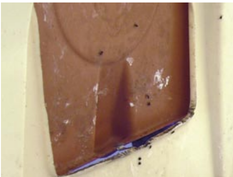
Figur 6 - Problemer med lukning af foderlågen i "La Buvette Logistar".
