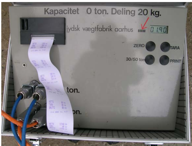
Figur 4. Kontrolvægtens betjeningspanel. Vægten angives i tons med 20 kg interval.
