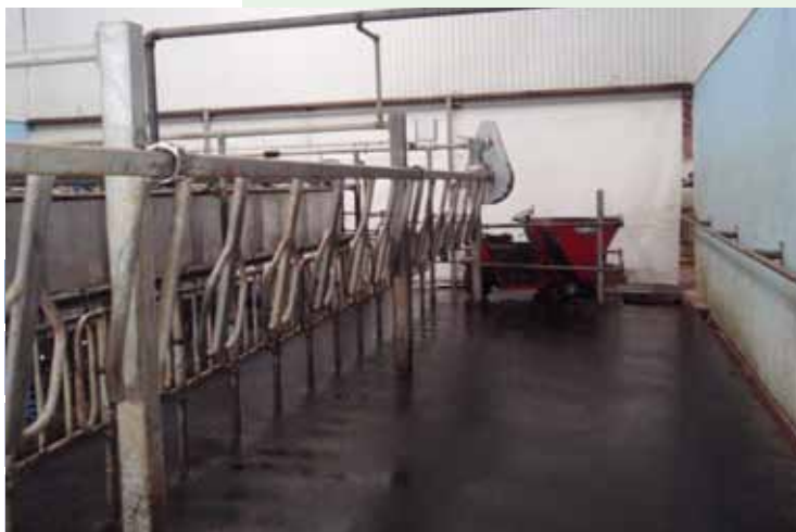
Figur 5.17. Pladsen foran malkeplatformen er for lille, det betyder at det er den tid køerne bruger på at komme ud af malkestalden, der bestemmer kapaciteten og ikke køernes reelle malketid.
