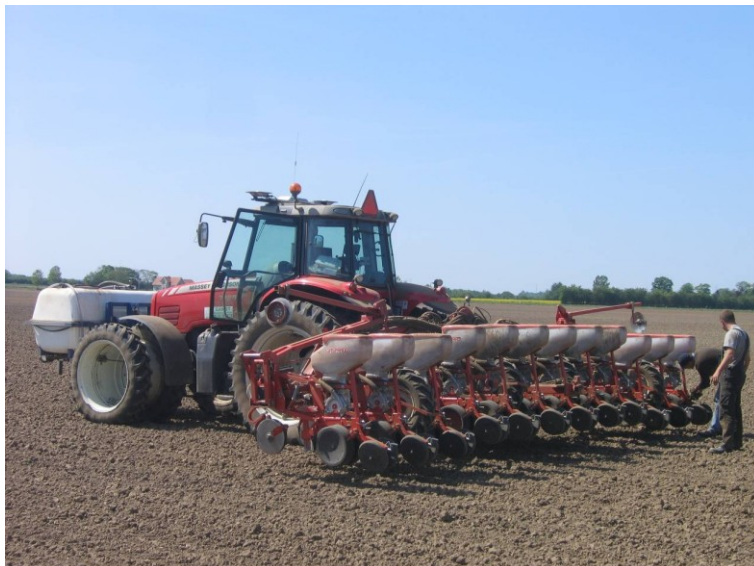
Gasparo majssåmaskine, 12 rækker, 9 m arbejdsbredde.
