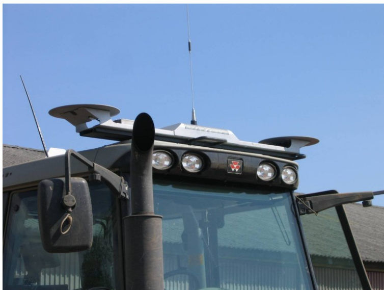
Autofarm GPS-autostyringssystem på traktor til såmaskine; samme GPS-system var monteret på Vredo gyllenedfælder.
