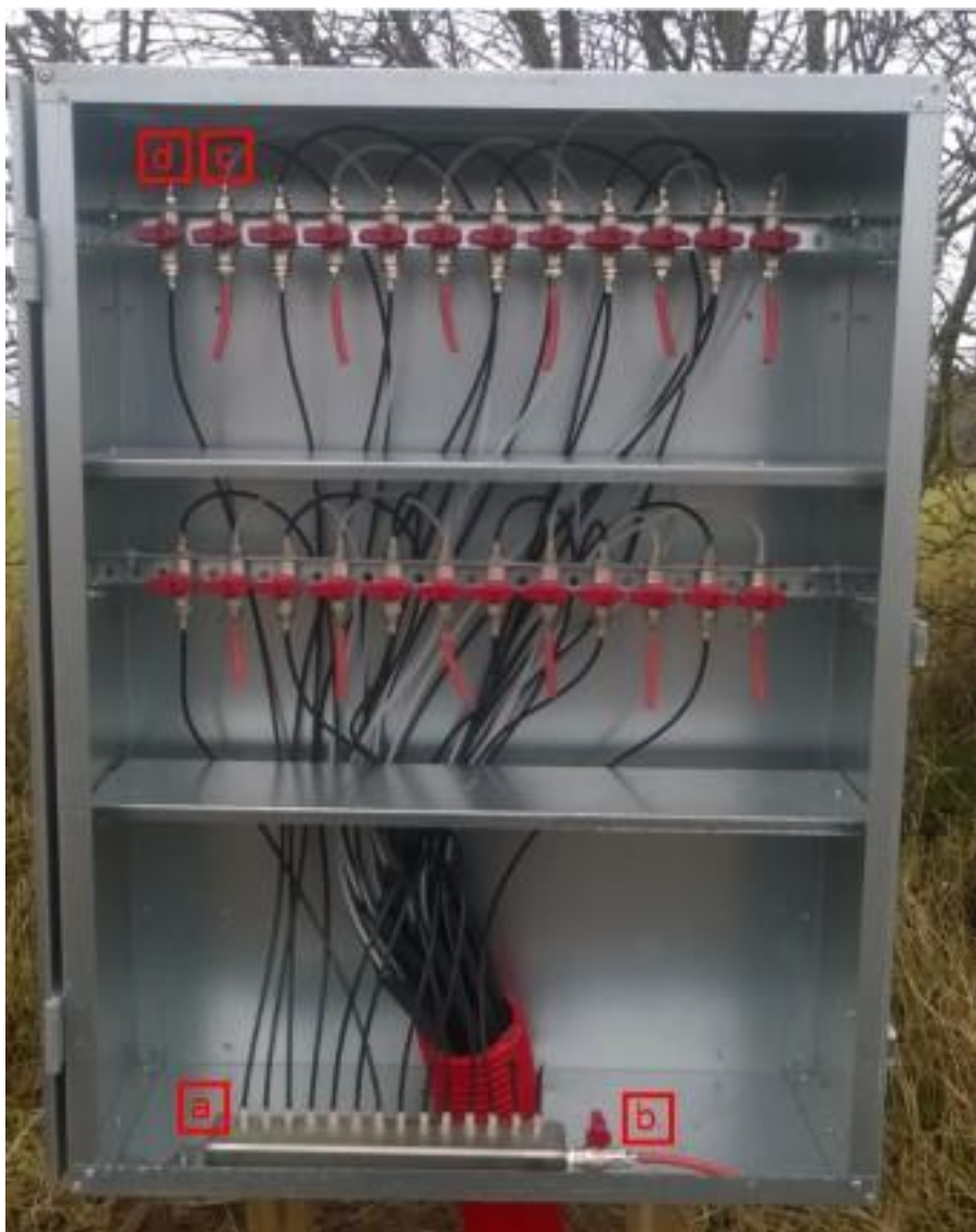
Figur 2. Billede af skab til prøveudtagning fra sugeceller. Perbøl. Foto: Kristoffer Piil, SEGES.
